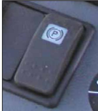
Figure 18 : Frein de parking jouant le rôle d'un réarmement
