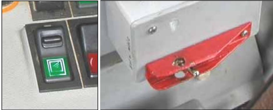
Figure 21 : Boutons d'activation d'ordinateur protégé (gauche) ou cadenasable (droite)
