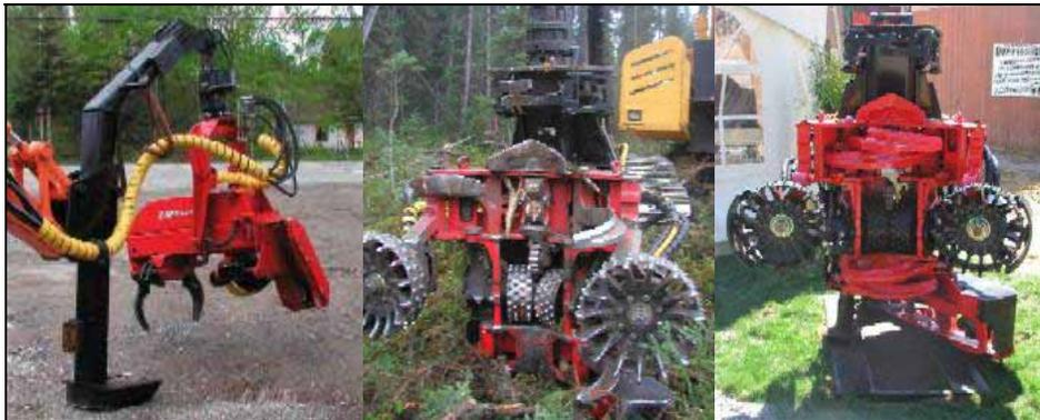
Figure 2 : Exemples de têtes d'abattage multifonctionnelles
