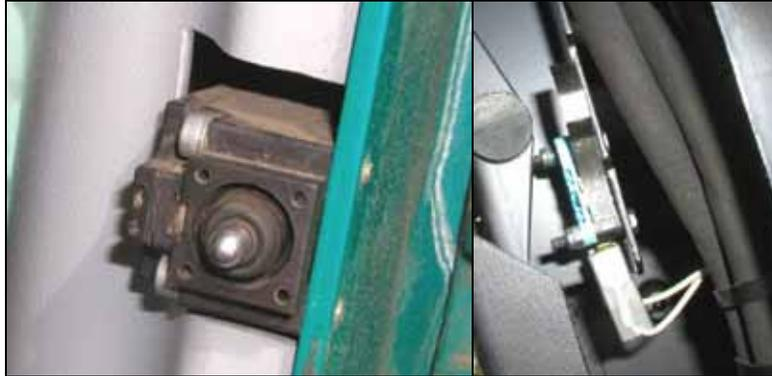
Figure 16 : Abatteuse L - interrupteurs électromécaniques de portière et d'accodoir
