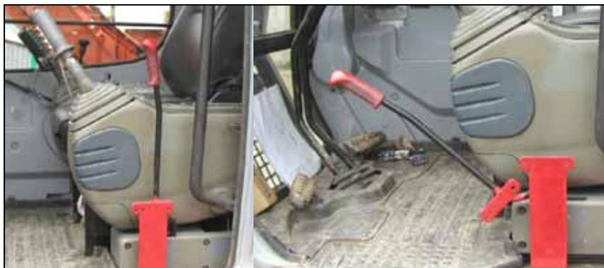
Figure 15 : Levier coupe-pilote hydraulique à action mécanique
