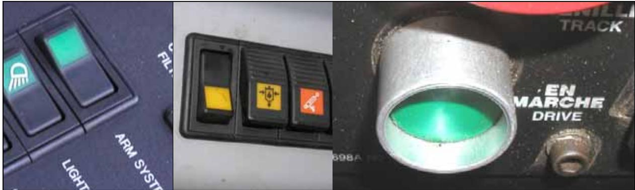
Figure 17 : Boutons à action momentanée pour le réarmement
