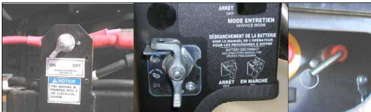
Figure 26 : Coupe-batterie fixe, fixe cadenassable et mobile
