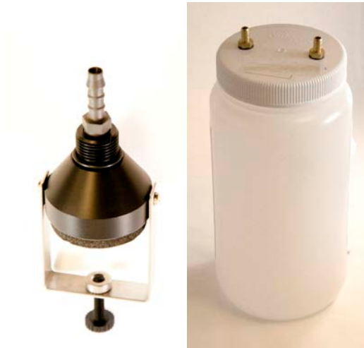
Figure A-4. Adaptateur (gauche) et jarre (droite) appropriés pour l'étalonnage de la pompe
