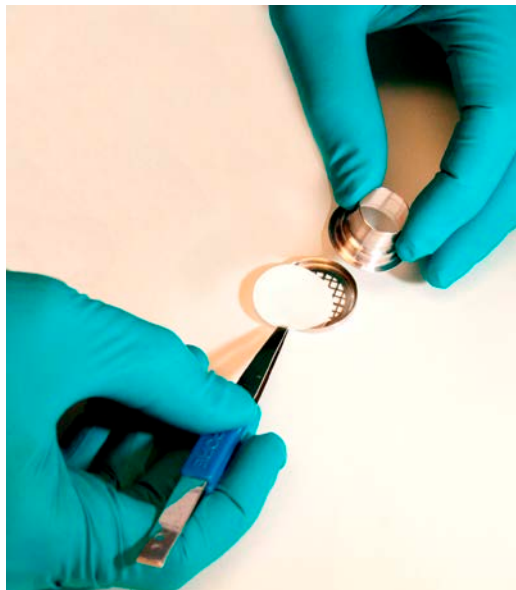
Figure A-1. Montage filtre dans cassette IOM en acier inoxydable
