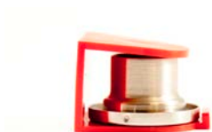
Figure A-3. Cassette IOM en acier inoxydable dans son porte-échantillon
