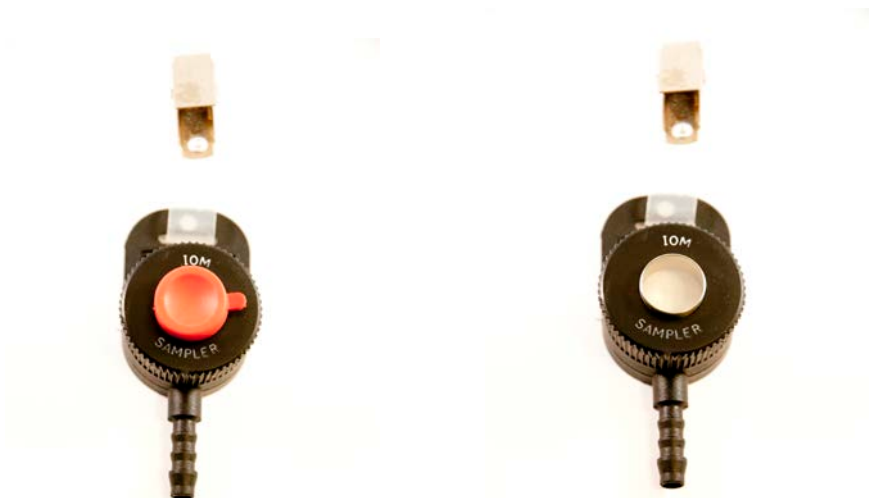
Figure A-2. Échantillonneur IOM avec capuchon (gauche) et sans capuchon (droite)
