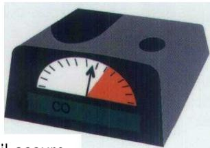
Cet appareil assure une surveillance continue de la concentration de monoxyde de carbone (CO) présente dans l'air ambiant. Un signal sonore et/ou visuel se déclenche lorsqu'une concentration ponctuelle (en un temps déterminé) et non souhaitable est dépassée.
