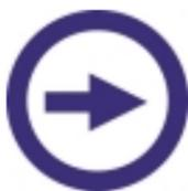
**Symbole normalisé servant à identifier les dispositifs à ouverture forcée**
