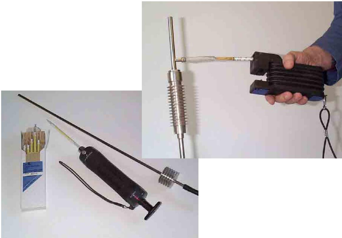
Figure 7. Échantillonnage du monoxyde de carbone à l'aide de tubes colorimétriques
