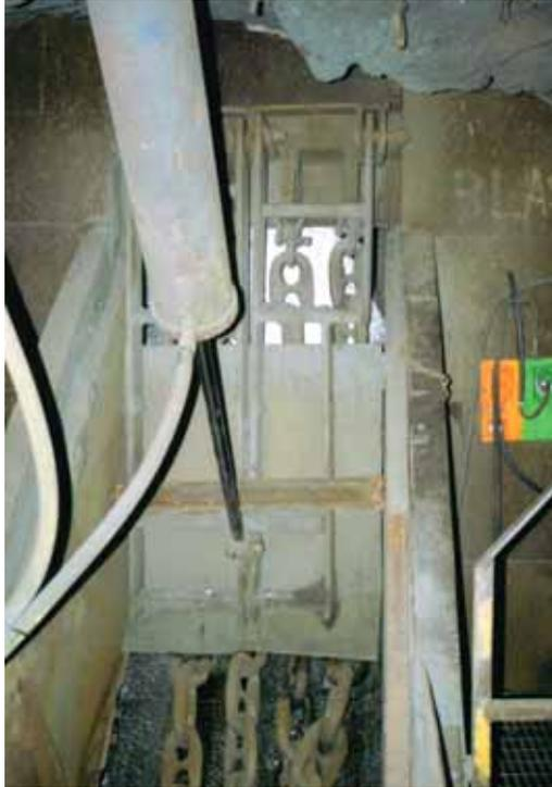
Figure 4.3. Rideau de chaînes de contrôle, méthode d'actionnement directe par un poussoir actionné par un cylindre pneumatique ou hydraulique.
