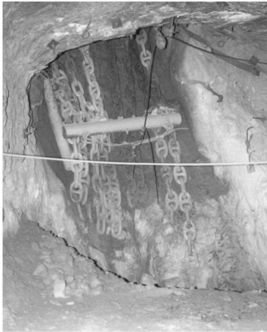
Figure 3.1. Chaînes de contrôle utilisées seules.
