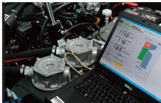
11. Mesure de concentration des gaz d'émissions entre le moteur et le catalyseur
