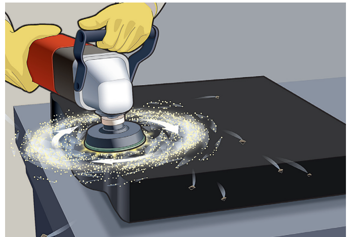
Figure 7 : Tourbillon de particules créé par des outils rotatifs à grande vitesse
