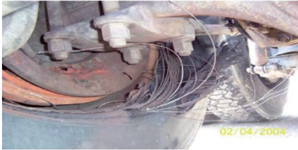
Photo n° 1 : Pneu ayant éclaté à la suite de la surchauffe des freins (blocage)
