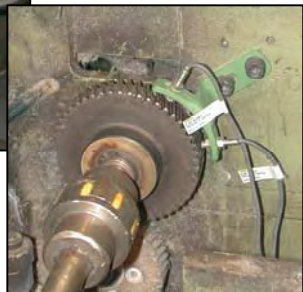
Détail des dispositifs de détection de rotation (détecteurs de proximité inductifs)
