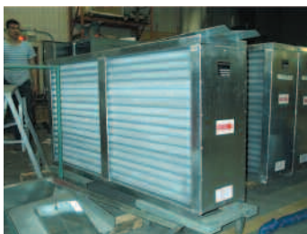
3.17 Récupérateur à tuyaux thermique
