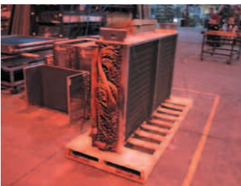
3.6 Serpentin de refroidissement à expansion directe
