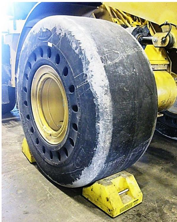
**Figure 11 : Calage d'une roue de la chargeuse.**
