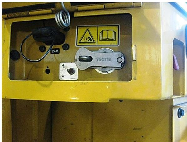
**Figure 12 : Coupe-batterie cadenassable de la chargeuse prêt à recevoir un morillon et les cadenas personnels de tous les intervenants.**
