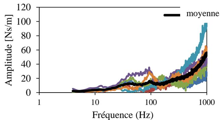
**Figure 5.5 : Comparaison de l'amplitude de l'impédance des doigts de 6 sujets, telle que mesurée au moyen du capteur *FlexiForce*<sup>®</sup> avec une force de préhension de 30 N, une force de poussée de 50 N et une excitation de 1,5 m/s<sup>2</sup>.**
