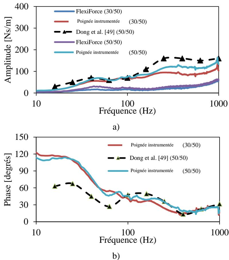
**Figure 5.7** Comparaison des réponses en impédance moyennes des doigts obtenues au moyen de la poignée instrumentée et du capteur *FlexiForce*<sup>®</sup> avec les données rapportées par Dong et al. [49], sous une excitation de  $1,5 \text{ m/s}^2$  : a) amplitude ; b) phase.
