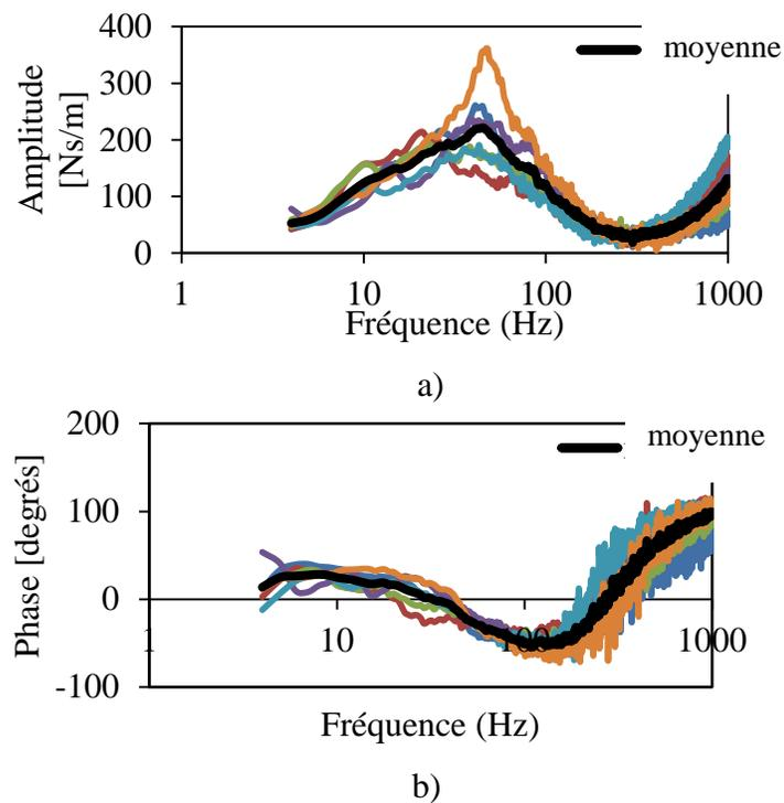
**Figure 5.3 : Comparaison de l'impédance de la paume de 6 sujets, telle que mesurée au moyen du capteur *FlexiForce*<sup>®</sup> avec une force de préhension de 30 N, une force de poussée de 50 N et une excitation de  $1,5 \text{ m/s}^2$  : a) amplitude ; b) phase.**
