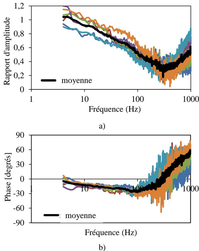
**Figure 5.8 : Caractéristiques des réponses en fréquence du capteur *FlexiForce*<sup>®</sup> dérivées des réponses en impédance de la paume des 6 sujets (traits colorés). Les valeurs moyennes sont représentées par un trait noir : a) rapport d'amplitude ; b) phase (force de poussée : 50 N, force de préhension : 30 N, excitation :  $1,5 \text{ m/s}^2$ ).**
