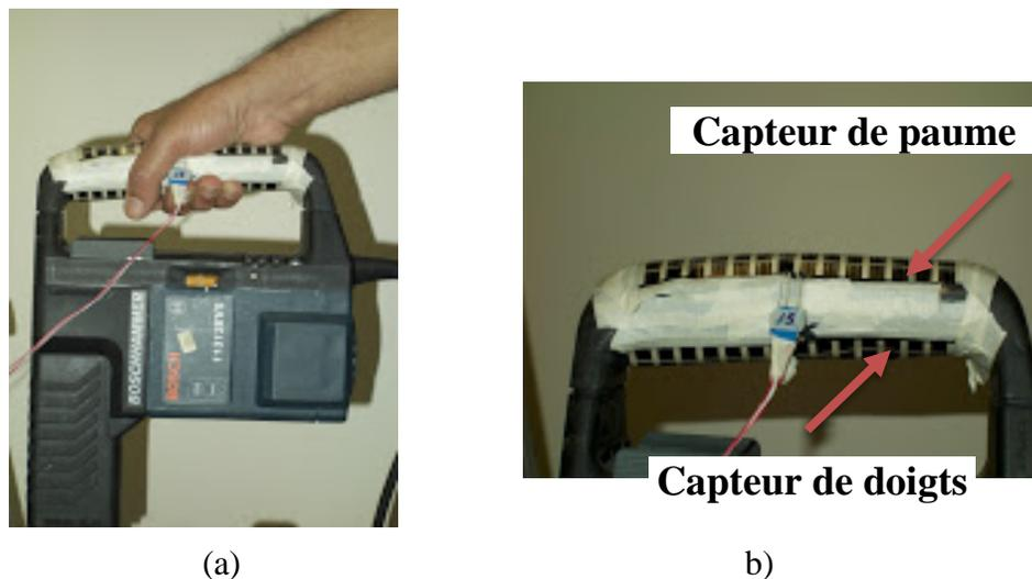
Figure 6.2 : a) Position de la main de l'opérateur sur les capteurs de paume et de doigts de la poignée principale ; b) capteurs *FlexiForce*<sup>®</sup> de paume et de doigts installés sur la poignée.
