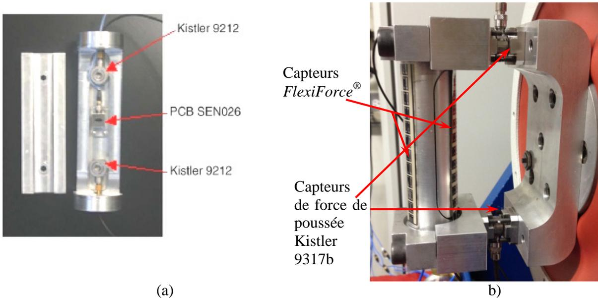
Figure 4.8 : a) Poignée fendue équipée de capteurs de force de préhension et d'un accéléromètre ; b) poignée munie de capteurs *FlexiForce*<sup>®</sup> montés sur des capteurs de force de poussée.
