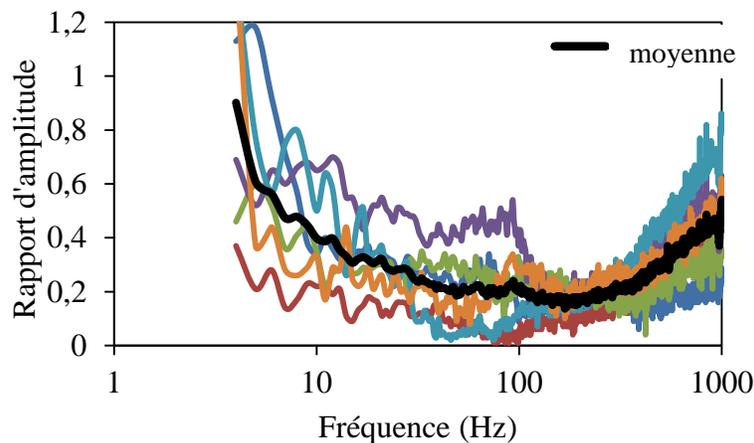
**Figure 5.9 : Caractéristiques des réponses en fréquence du capteur *FlexiForce*<sup>®</sup> dérivées de l'amplitude de l'impédance des doigts des 6 sujets (traits colorés). Les valeurs moyennes sont représentées par un trait noir (force de poussée : 50 N, force de préhension : 30 N, excitation : 1,5 m/s<sup>2</sup>).**
