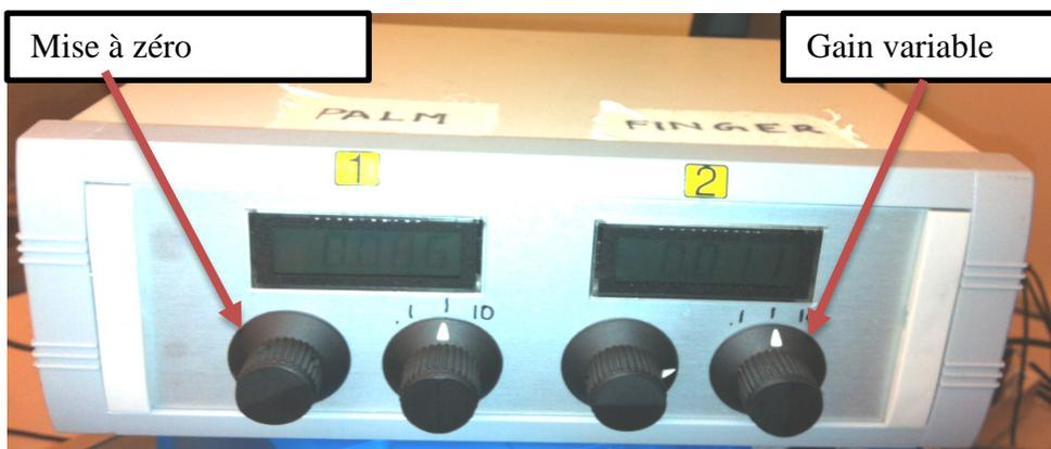
**Figure 3.3 : Conditionneur de signal à deux canaux développé pour enregistrer simultanément les signaux des capteurs *FlexiForce*<sup>®</sup> côté doigts et côté paume.**
