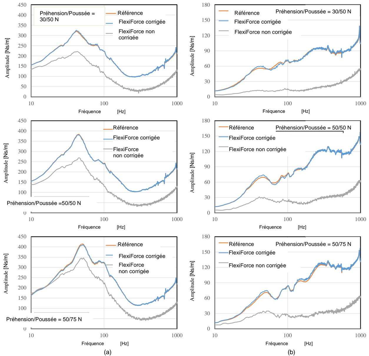
**Figure 5.12 : Réponses en impédance corrigées et non corrigées obtenues au moyen des capteurs *FlexiForce*<sup>®</sup> comparées à la réponse de référence obtenue au moyen de la poignée instrumentée sous une excitation de  $1,5 \text{ m/s}^2$  : a) impédance de la paume ; b) impédance des doigts.**
