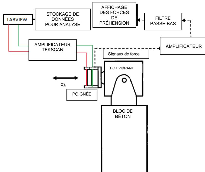
Figure 4.1 : Montage expérimental pour l'étalonnage de capteurs *FlexiForce*® installés sur des poignées instrumentées [41,42].
