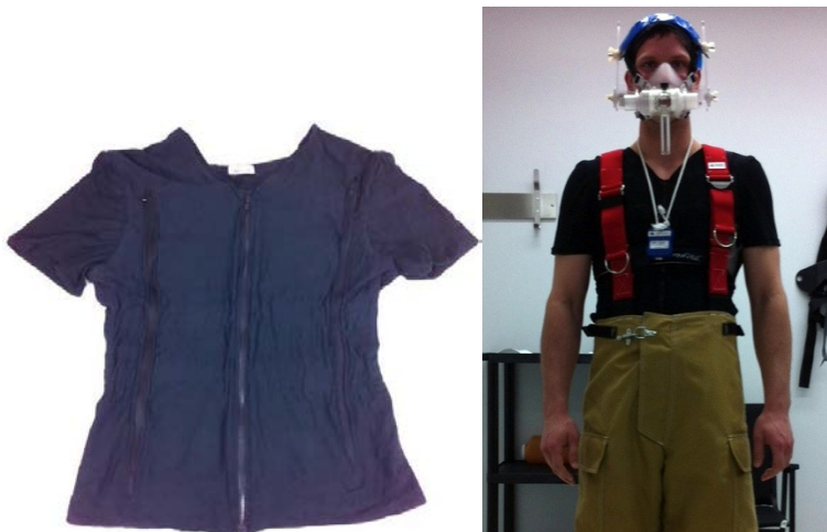
Figure 3.4 Prototype de veste du volet 2, composée d'un tissu conducteur et confortable pouvant être porté directement sur le corps.
