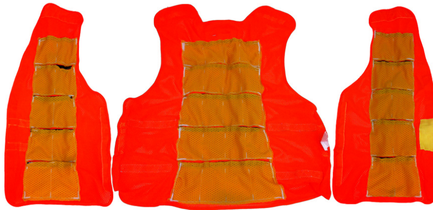
Figure 3.3 Prototypage de veste du volet 1, permettant de contenir les sachets de MCP dans leur forme assemblée.
