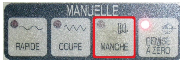
Figure 8 – Bouton de sélection de la télécommande (« manche »).
