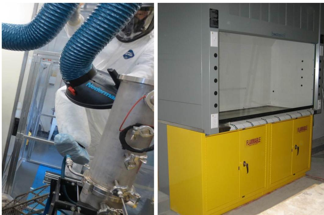
**Figure A2 : Système de captation à la source et hotte de laboratoire.**
