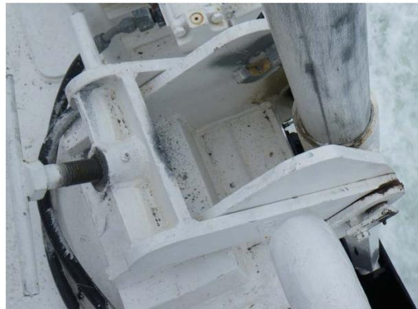
Rail de guidage : Permet de retenir et de guider les tiges lorsque les ailerons sont déployés. Une goupille de retenue est enfoncée dans le bas de ce rail pour retenir la tige en place.
