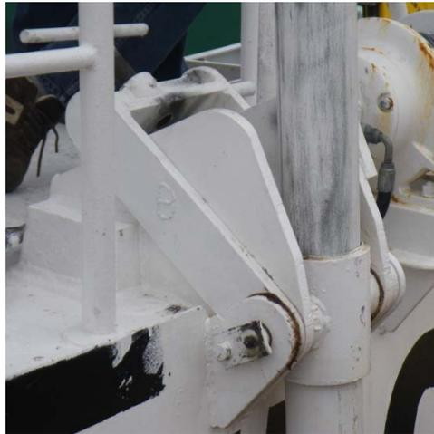
Loquet de retenue : Il s'agit d'une pièce mobile fixée sur le pivot de guidage, il se rabat sur le bout de la tige de retenue pour la retenir lors de la mise en place de l'aileron.
