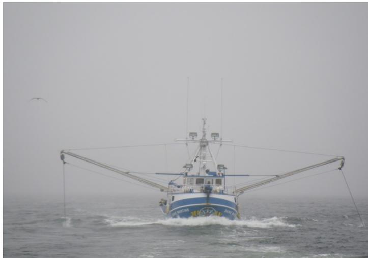
**Figure 1. Système d'amortissement du roulis à paravanes.**
