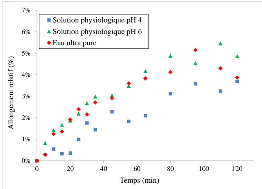
**Figure 40 – Variation de l’allongement relatif du nitrile en fonction du temps d’immersion dans des solutions physiologiques de pH 4 et pH6 et dans l’eau ultra pure**
