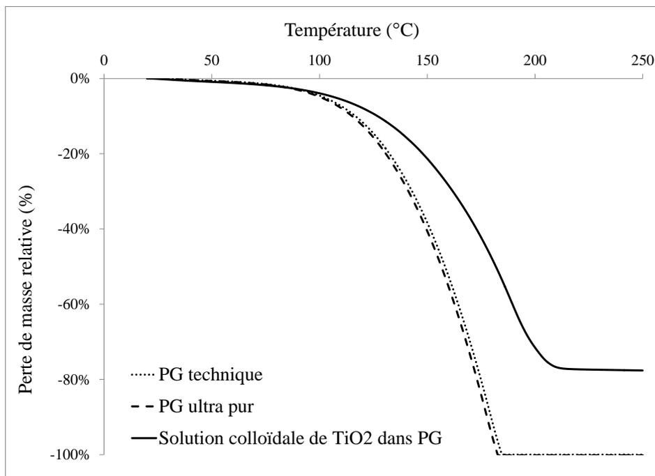
**Figure 16 – Variation de la perte de masse en fonction de la température donnée par analyse TGA de la solution colloïdale de NPs de TiO<sub>2</sub> dans le PG et du PG de qualité technique et ultra pure**
