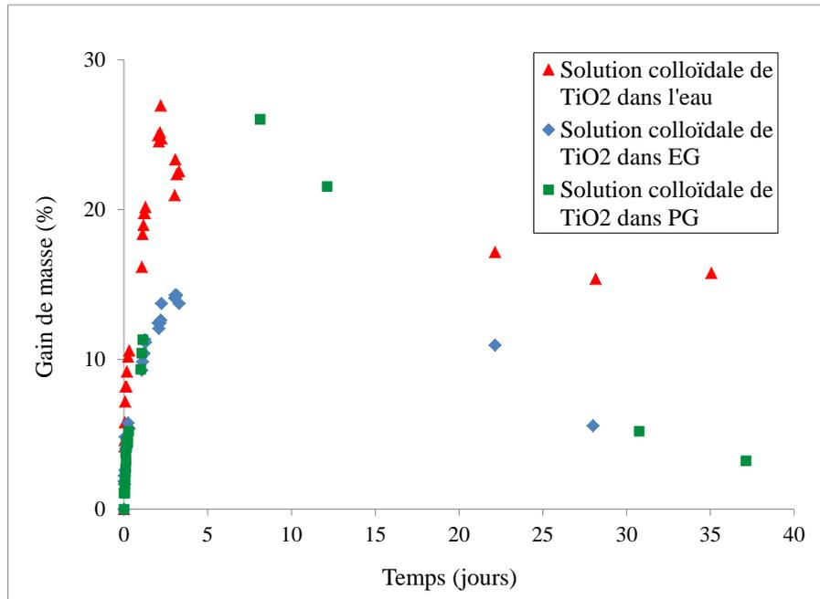
**Figure 31 - Variation du gain de masse du latex en fonction du nombre de jours d’immersion dans les solutions colloïdales de TiO<sub>2</sub> dans l’eau, dans l’EG et dans le PG**
