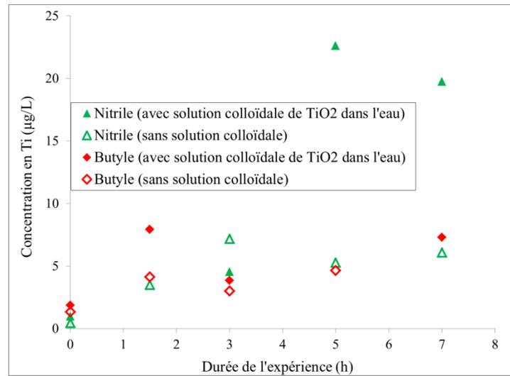
**Figure 45 - Mesures par ICP-MS de la quantité de titane dans la solution d'échantillonnage en fonction de la durée de l'expérience pour le nitrile et le butyle exposés ou non à la solution colloïdale de TiO<sub>2</sub> dans l'eau en plus des sollicitations dynamiques biaxiales**
