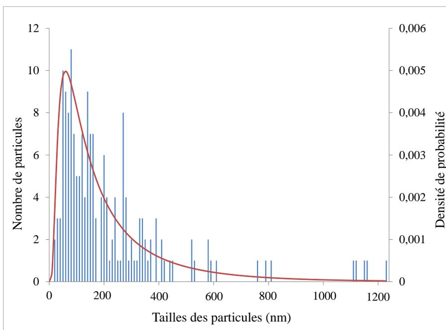
**Figure 15 - Distribution en taille des particules de la poudre de TiO<sub>2</sub> basée sur le diamètre circulaire mesuré à partir de clichés MET et courbe de lissage par une loi gaussienne inverse**
