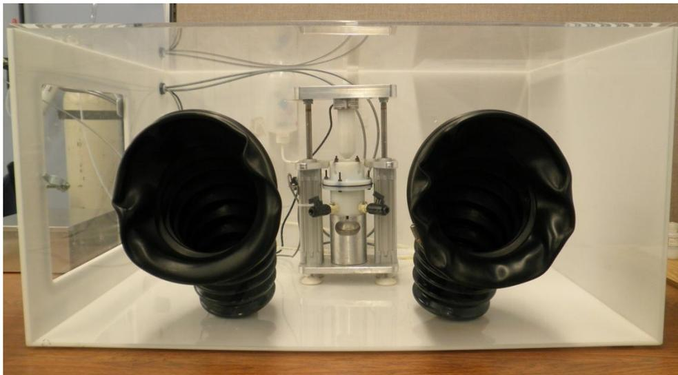
**Figure 5 - Boîte à gants avec dispositif expérimental**
