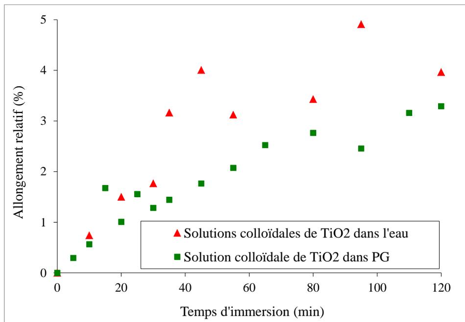
**Figure 32 – Variation de l’allongement relatif du nitrile (orientation transverse) en fonction du temps d’immersion dans les solutions colloïdales de TiO<sub>2</sub> dans l’eau et dans le PG**
