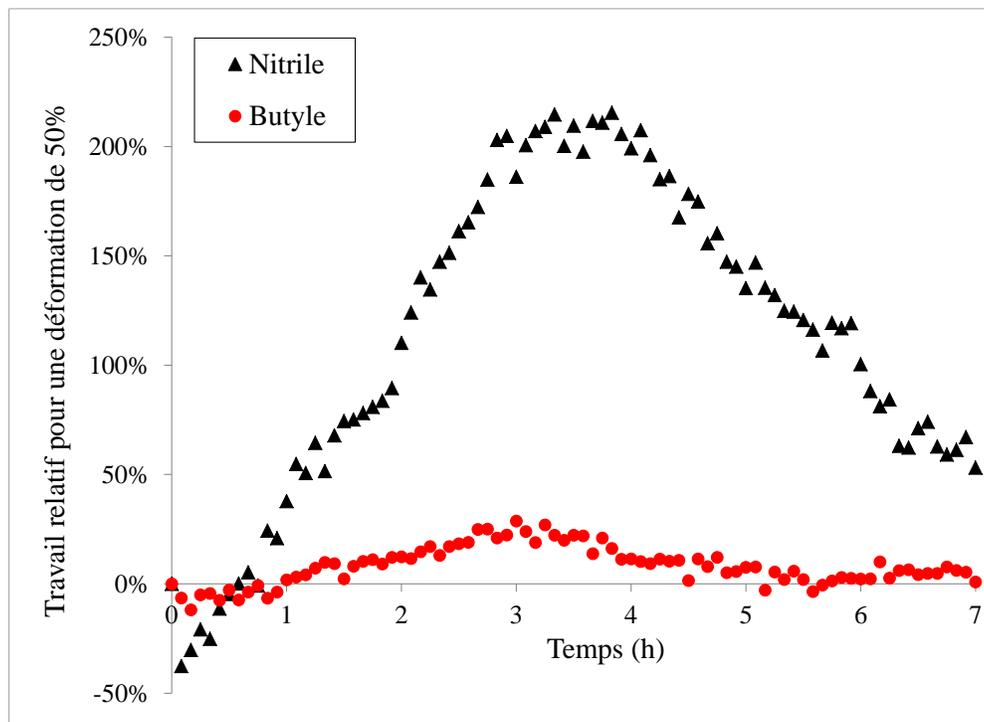
**Figure 23 – Variation relative du travail correspondant à une déformation biaxiale de 50% d'un échantillon de butyle et de nitrile en fonction de la durée d'exposition aux sollicitations mécaniques biaxiales (une déformation toutes les 5 minutes)**
