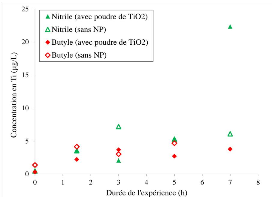
**Figure 42 – Mesures par ICP-MS de la quantité de titane dans la solution d'échantillonnage en fonction de la durée de l'expérience pour le nitrile et le butyle exposés ou non à de la poudre de TiO<sub>2</sub> en plus des sollicitations dynamiques biaxiales**
