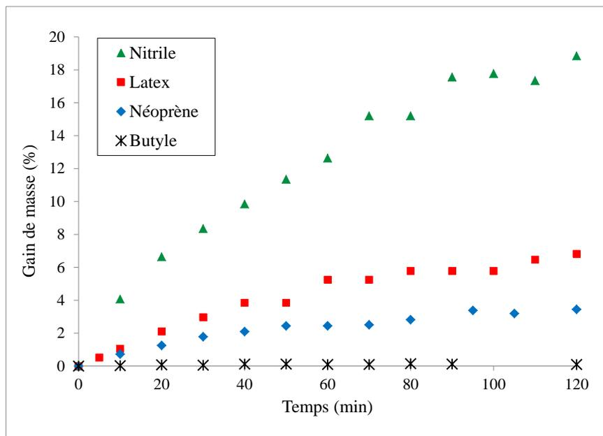
**Figure 29 - Variation du gain de masse du nitrile, du latex, du néoprène et du butyle en fonction du temps d’immersion dans la solution colloïdale de TiO<sub>2</sub> dans l’eau**
