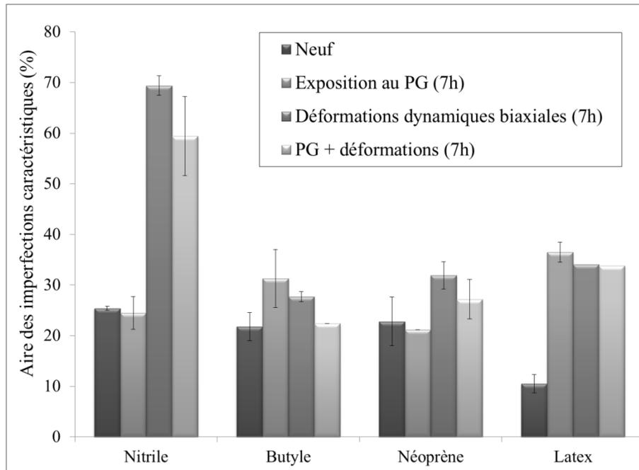
**Figure 38 – Effets d'une exposition de 7h au PG, à des déformations dynamiques biaxiales et à la combinaison des deux sur l'aire des imperfections des gants en nitrile, butyle, néoprène et latex (surface externe)**
