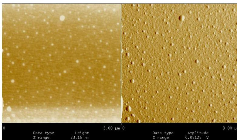
**Figure 43 – Image AFM à une échelle de 3 µm d'une solution d'échantillonnage dans l'eau pure centrifugée sur un substrat de mica correspondant à un échantillon de nitrile soumis pendant 7 heures à des déformations dynamiques biaxiales (50%) et à de la poudre de TiO<sub>2</sub>**
