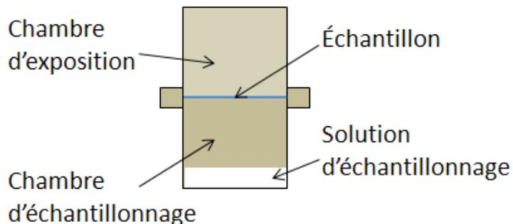
**Figure 10 - Schéma du montage avec solution d'échantillonnage**
