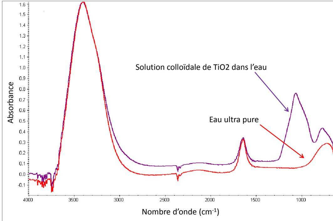
**Figure 17 – Comparaison des spectres FT-IR de la solution colloïdale de TiO<sub>2</sub> dans l'eau et de l'eau ultra pure**
