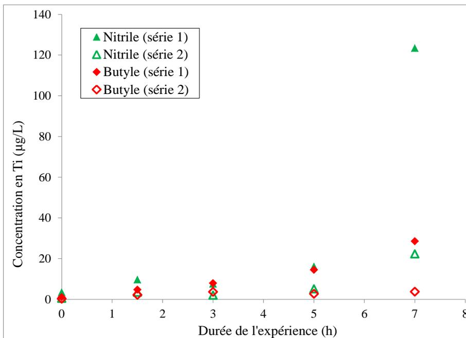
**Figure 41 - Mesures par ICP-MS de la quantité de titane dans la solution d'échantillonnage en fonction de la durée de l'expérience pour le nitrile et le butyle exposés simultanément à de la poudre de TiO<sub>2</sub> et à des sollicitations dynamiques biaxiales : comparaison de deux séries de tests**
