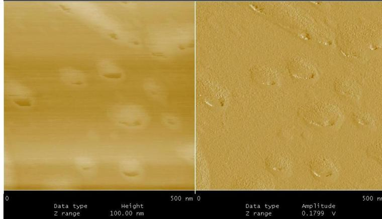
**Figure 44 – Image AFM à une échelle de 500 nm d’une solution d’échantillonnage dans l’eau pure centrifugée sur un substrat de mica correspondant à un échantillon de nitrile soumis pendant 7 heures à des déformations dynamiques biaxiales (50%) et à de la poudre de  $\text{TiO}_2$**
