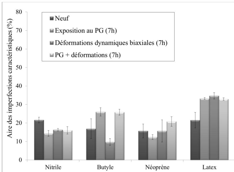
**Figure 39 - Effets d'une exposition de 7h au PG, à des déformations dynamiques biaxiales et à la combinaison des deux sur l'aire des imperfections des gants en nitrile, butyle, néoprène et latex (surface interne)**
