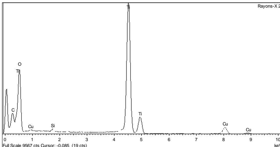
**Figure 14 - Spectre EDS de la poudre de TiO<sub>2</sub>**
