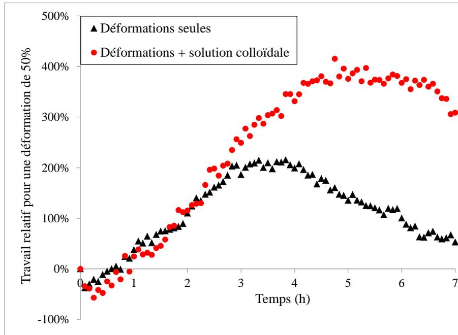
**Figure 35 – Variation relative du travail correspondant à une déformation biaxiale de 50% d'échantillons de nitrile en fonction de la durée d'exposition aux sollicitations mécaniques biaxiales (une déformation toutes les 5 minutes) combinées ou non à un contact avec la solution colloïdale de  $\text{TiO}_2$  dans l'eau**
