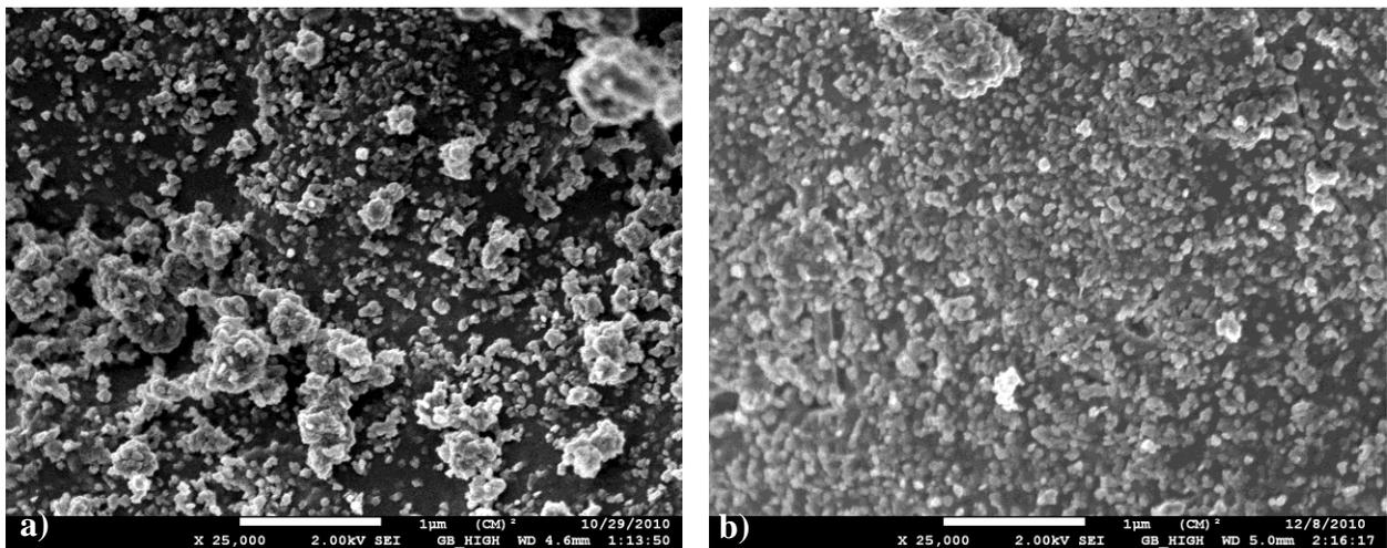
**Figure 24 – Clichés au MEB-FEG de la surface d'échantillons en néoprène exposés à de la poudre de la  $\text{TiO}_2$  conjointement avec des déformations dynamiques biaxiales de 50% pendant des durées de a) 1h 30 et b) 7h**
