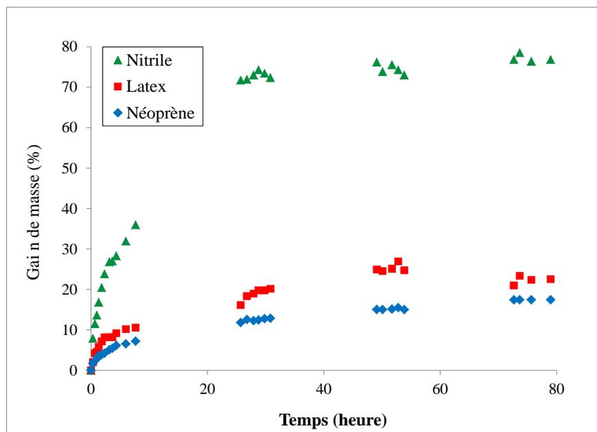
**Figure 30 - Variation du gain de masse du nitrile, du latex et du néoprène pour des longs temps d’immersion dans la solution colloïdale de TiO<sub>2</sub> dans l’eau**
