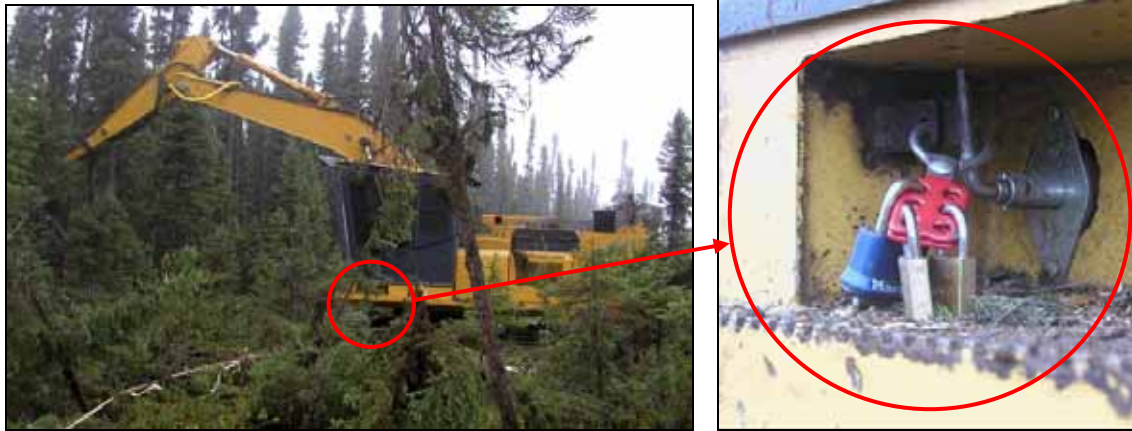
Figure 11 : Sectionneur situé immédiatement sous le devant de la porte, à l'extérieur
