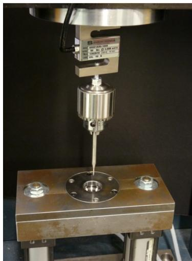
Figure 4 - Photo du montage de perforation
