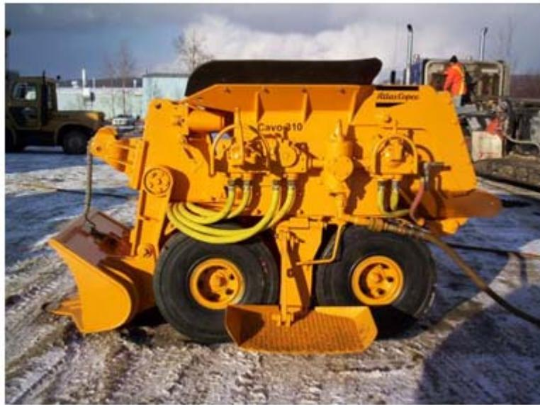
Figure 6. Rétrocaveuse sur roues CAVO310
