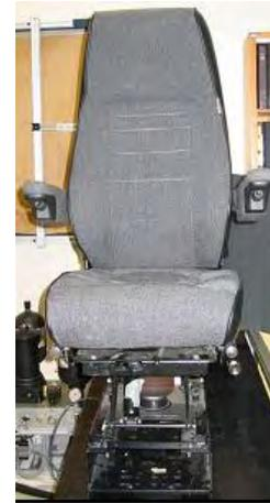
**Figure 12. Siège-R, à suspension pneumatique, servant de référence**
