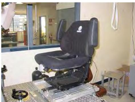
**Figure 16. Siège à suspension mécanique au dossier avec son assise originale (D)**
