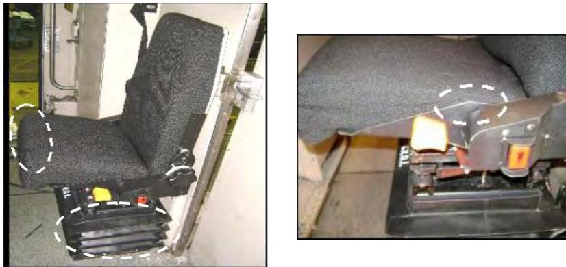
**Figure 39. Caractéristiques du siège associées aux inconforts ressentis par les opérateurs**
