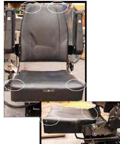
**Figure 20. Points d'inconfort associés au siège**
