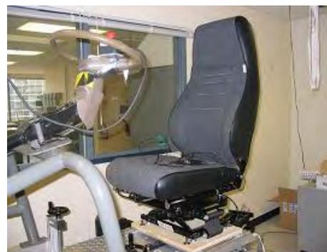
**Figure 15. Suspension pneumatique (E), pivotée de 90 degrés, assise-R**
