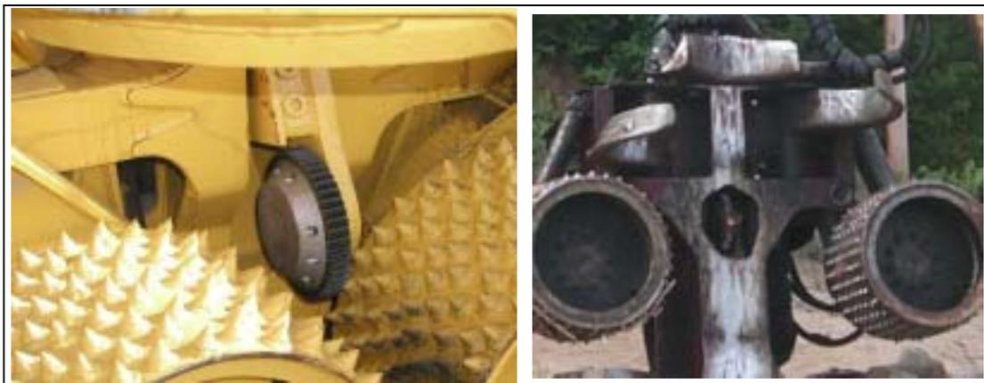
Figure 8 : Position de la roue de mesurage dans les têtes d'abattage multifonctionnelles.
