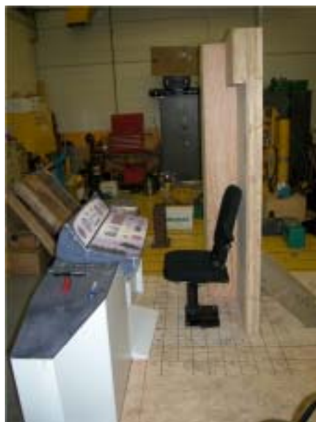
Figure 3.3 Maquette du pupitre fabriquée en carton mousse et installation pour les simulations
