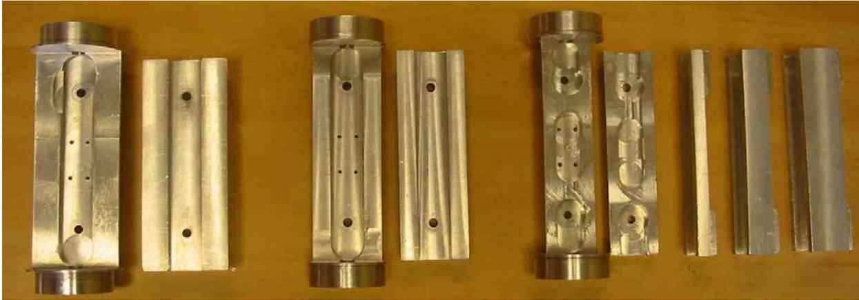
**Figure 4. De gauche à droite : poignées cylindriques de 50 mm, 40 mm et 30 mm;
