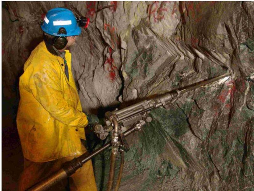
**Figure 1. Foreuse à béquille en situation de forage**
