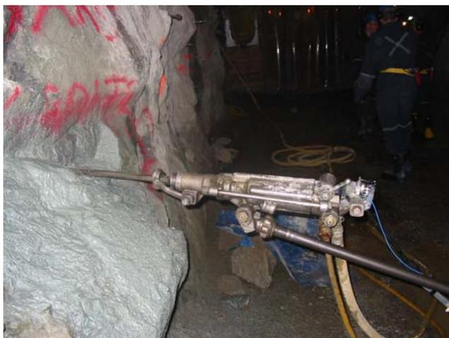
Figure 18. Foreuse à béquille en position de forage
