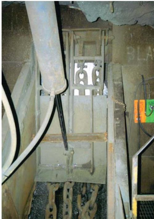
Figure 4.4. Rideau de chaînes de contrôle dans une chute, méthode d'action directe par un poussoir.
