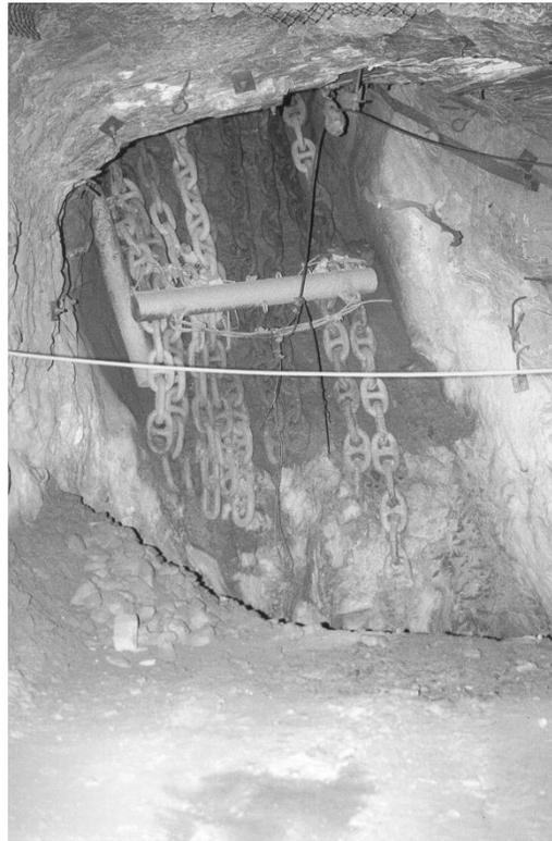
Figure 4.2. Chaînes de contrôle utilisées seules.
