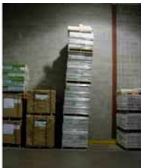
Figure 11 : Stabilité des charges (pile instable)
