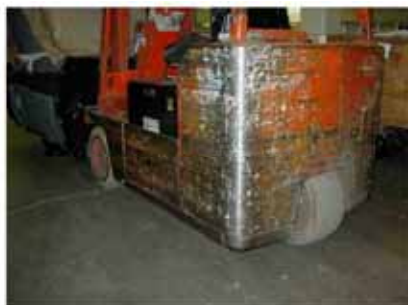
Figure 24 : L'usure évoque de nombreux frottements ou collisions
