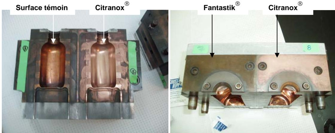
**Figure 10 : Nettoyage des surfaces (intérieures et extérieures du moule) avec la solution acide**
