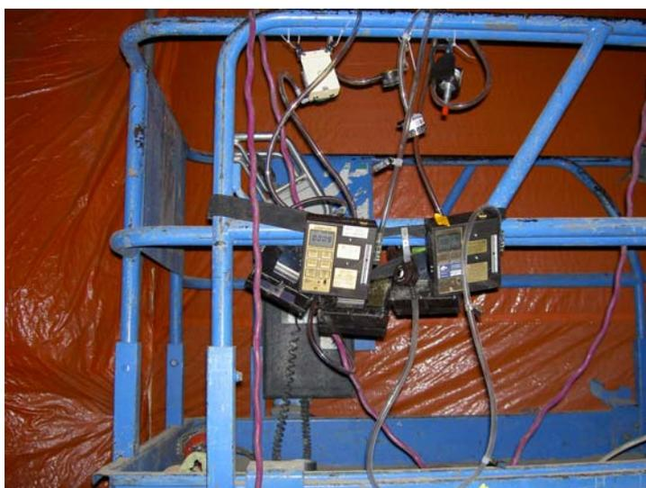
Figure 14 : Poste ambiant avec collecteurs attachés à la nacelle
