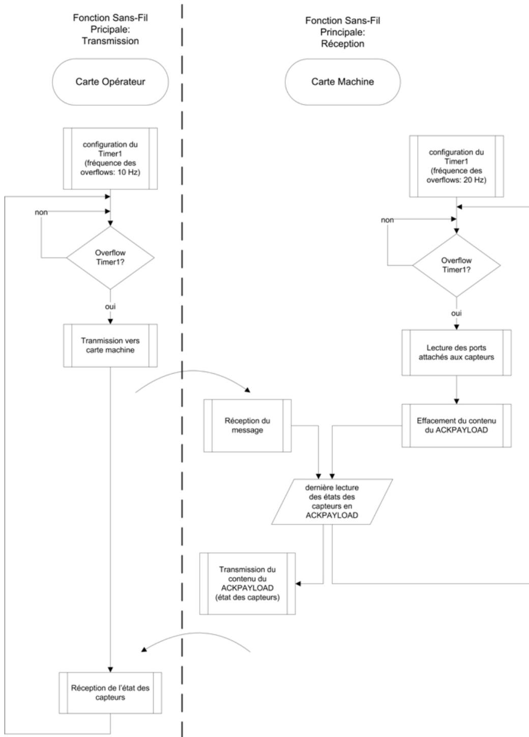
Figure C.1: Vérification des états des capteurs
