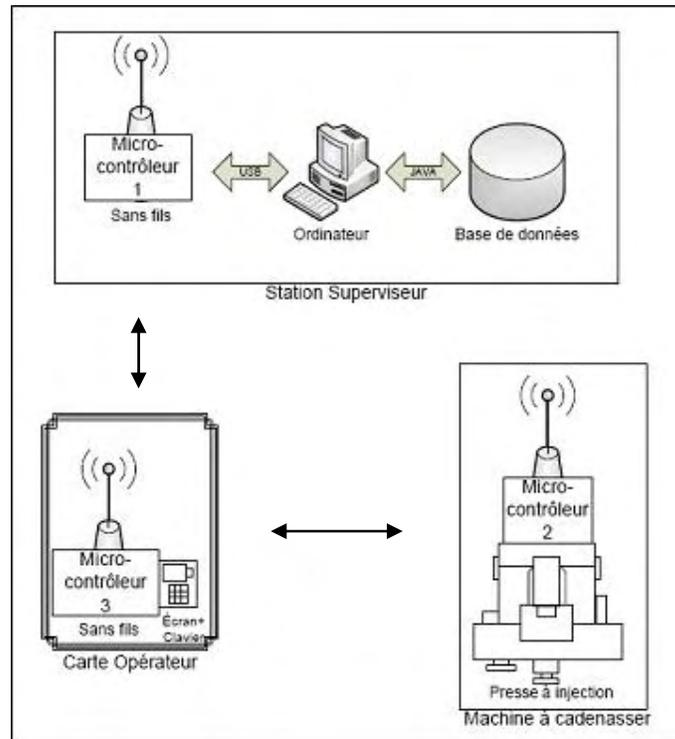
**Figure 17: Vue d'ensemble pour la solution retenue**
