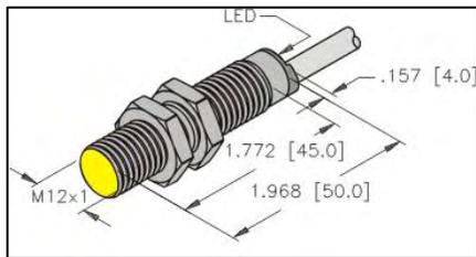
**Figure 23: Capteur de proximité pour vanne d'eau**
