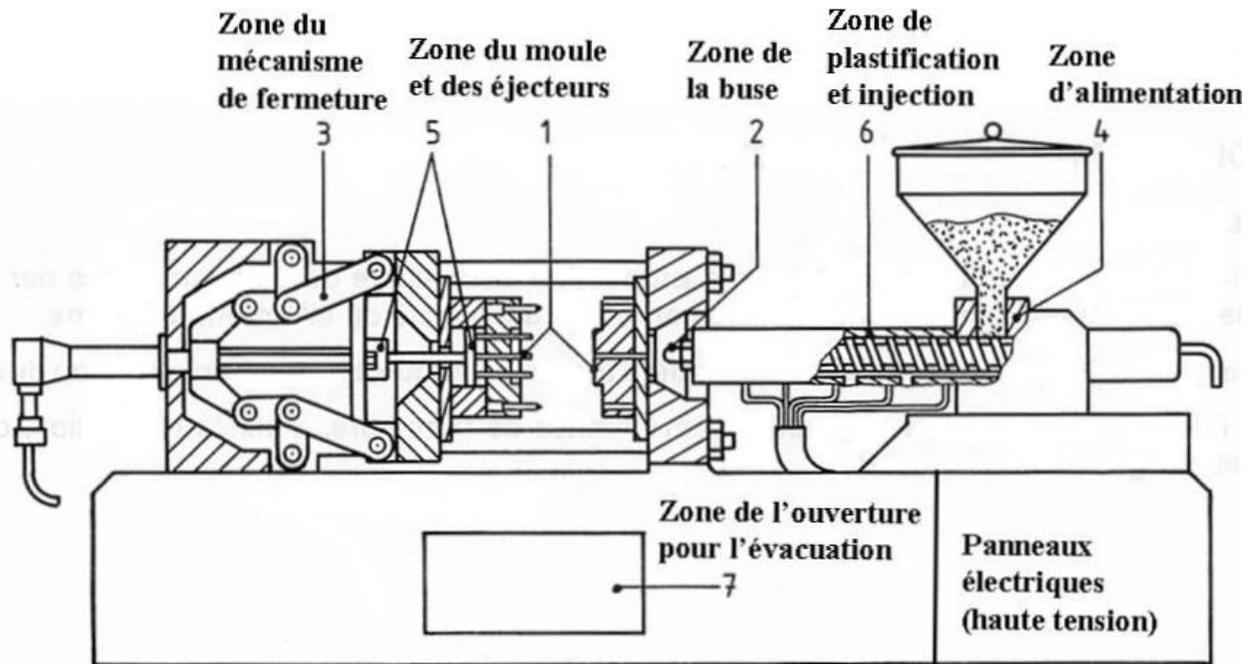
Figure 5: Zones dangereuses de la presse à injection
