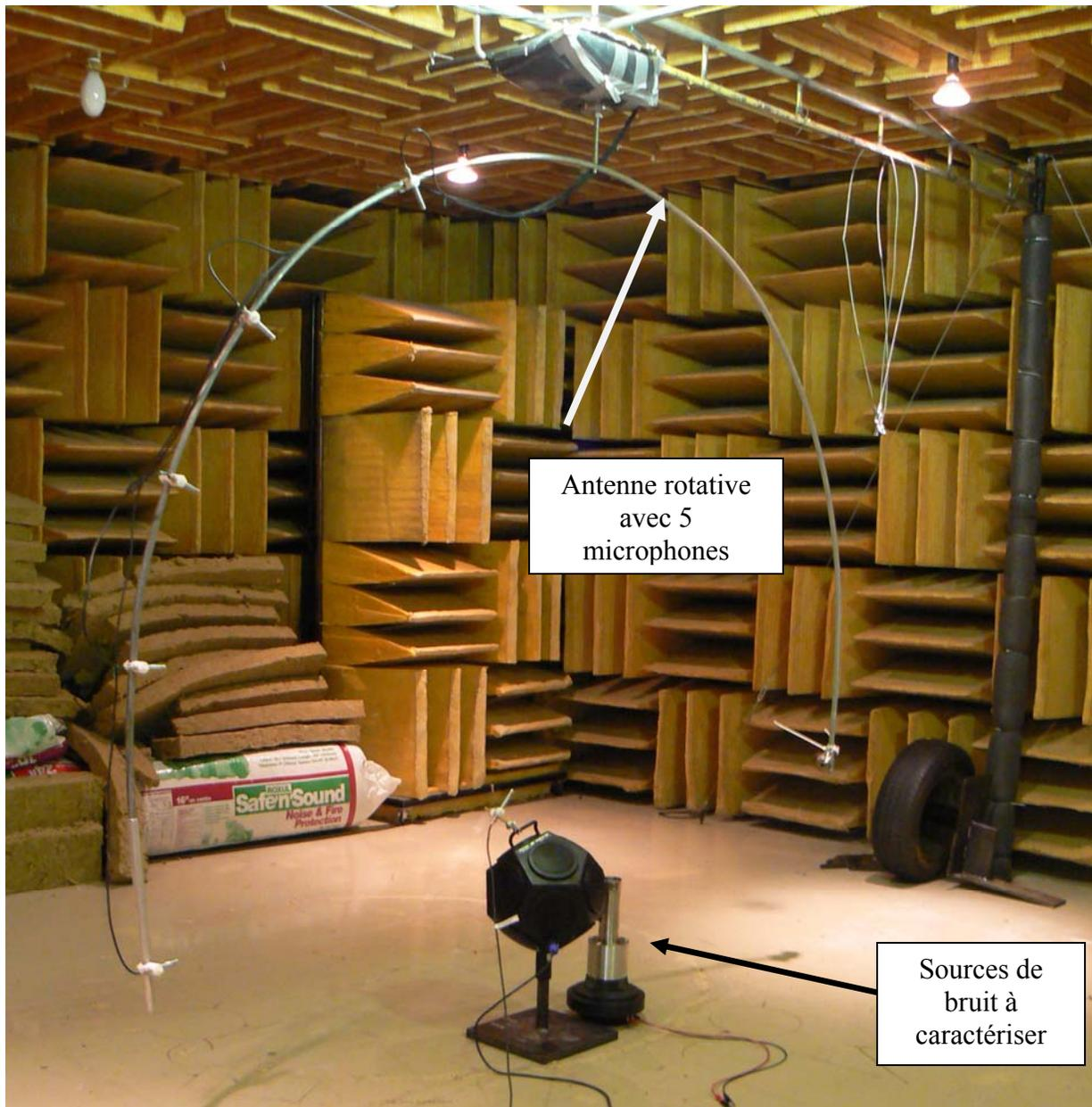
Figure 9 : Antenne rotative pour mesurer la puissance acoustique des sources de bruit utilisées pour créer le champ sonore dans les encoffrements testés
