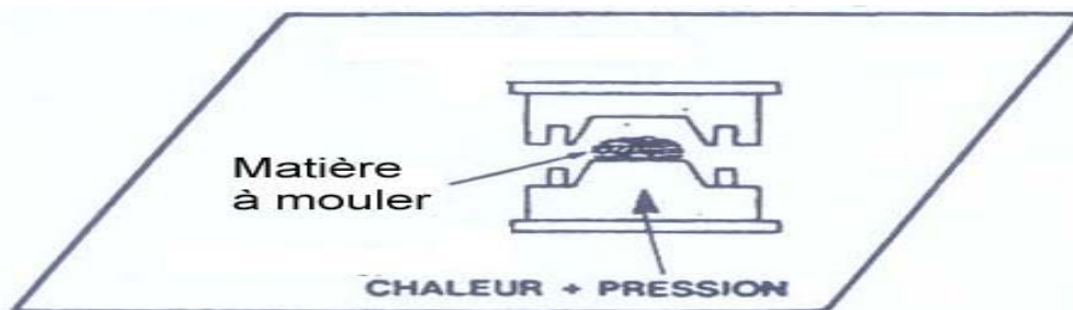
Figure 4 Schéma d'un moule pour le moulage par compression
