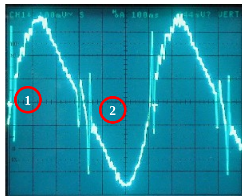
Figure 18 : Sous équilibrage – P_g = 20 psi
