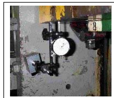
Figure 14 : Utilisation d'un seul comparateur sous le coulisseau
