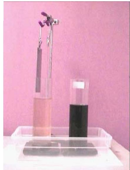
**Figure A- 1 Montage expérimental utilisé pour mesurer la vitesse d'égouttement des plaques de métal après les avoir trempées dans de l'huile de coupe (A) et pour permettre leur égouttement lors des essais expérimentaux avec les sujets (B)**
