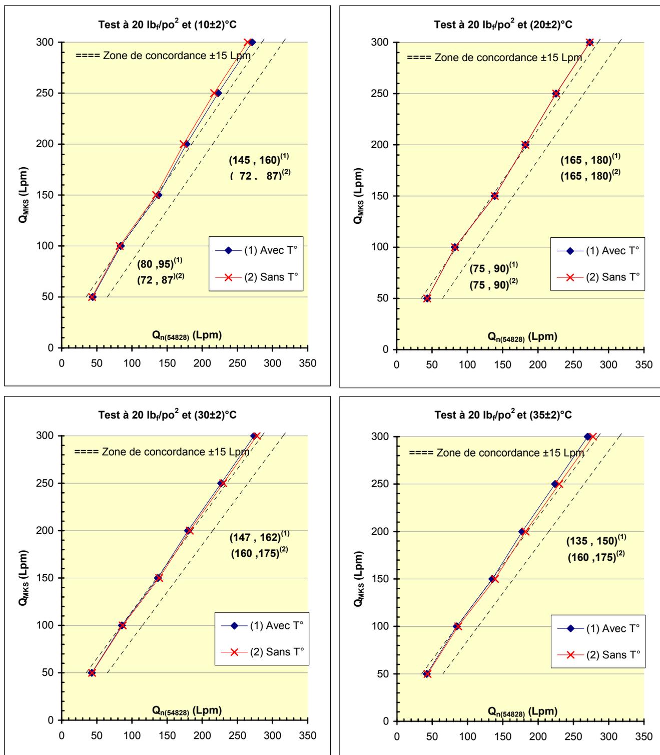
Figure 28 : Impact de la température sur le débit équivalent – Rotamètre Allegro à 20 lb<sub>f</sub>/po<sup>2</sup>
