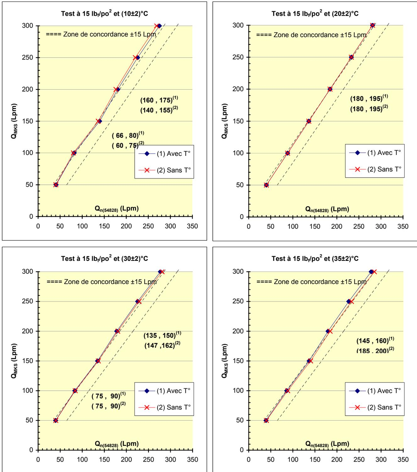
Figure 26 : Impact de la température sur le débit équivalent – Rotamètre Allegro à 15 lb<sub>f</sub>/po<sup>2</sup>
