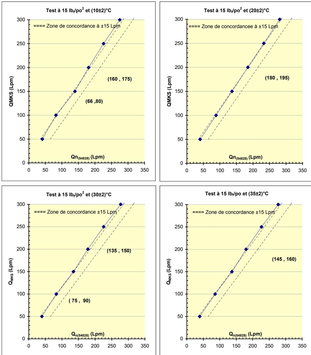
Figure 14 : Vérification des débits : écoulement à températures variables et à pression constante ( $P_u = 15 \text{ lb}_f/\text{po}_2$ ) – Rotamètre Allegro
