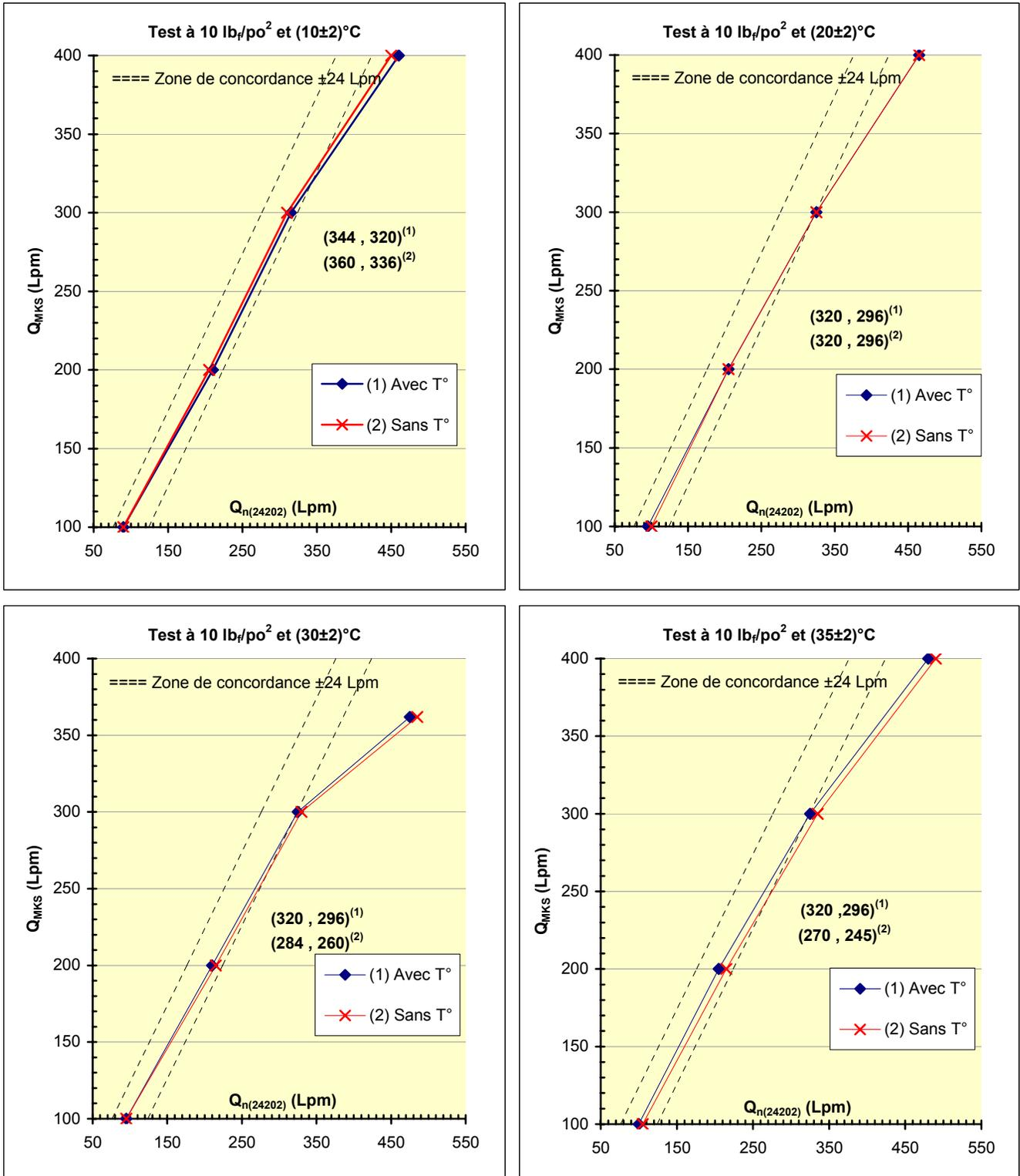
Figure 23 : Impact de la température sur le débit équivalent – Rotamètre Gilmont à 10 lb<sub>f</sub>/po<sup>2</sup>
