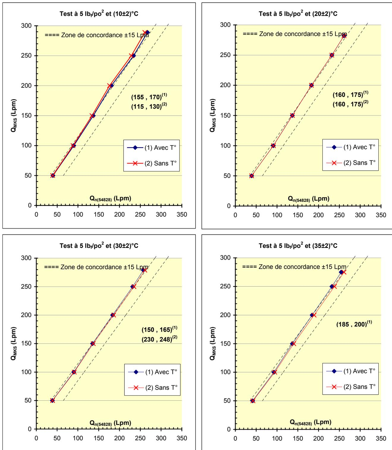
Figure 22 : Impact de la température sur le débit équivalent – Rotamètre Allegro à 5 lb<sub>f</sub>/po<sup>2</sup>
