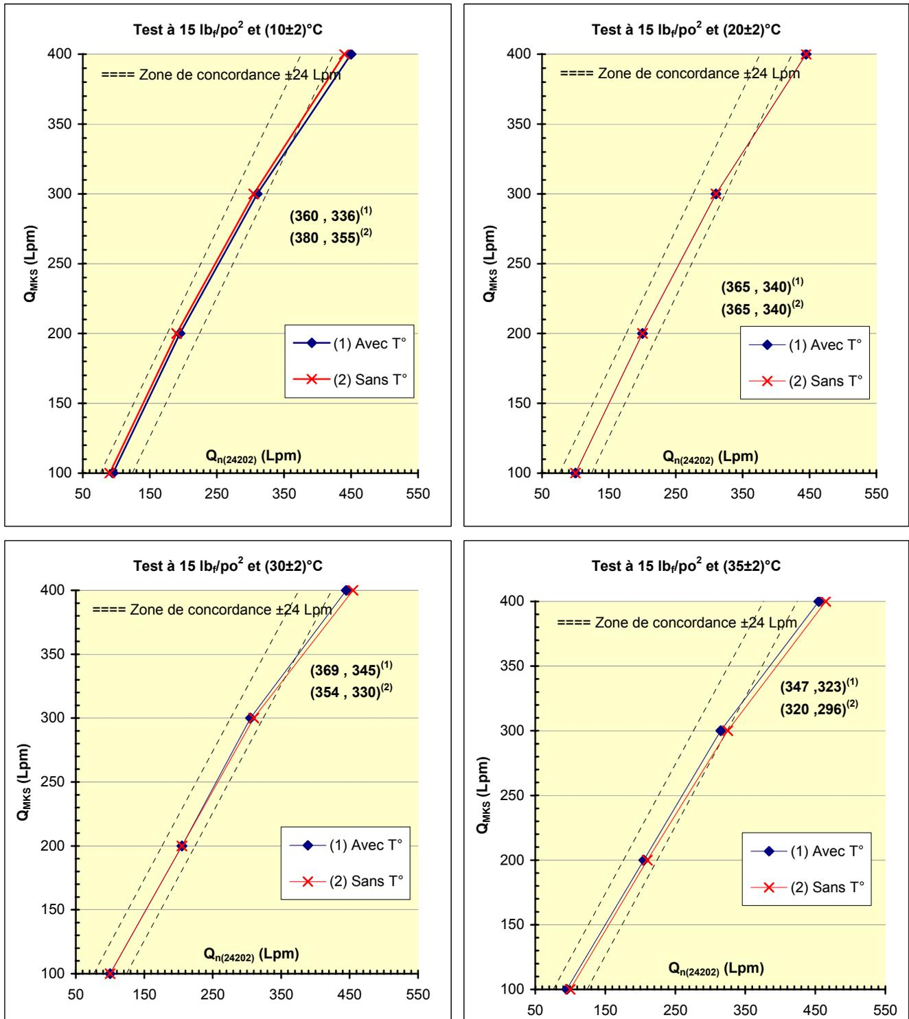
Figure 25 : Impact de la température sur le débit équivalent – Rotamètre Gilmont à 15 lb<sub>f</sub>/po<sup>2</sup>
