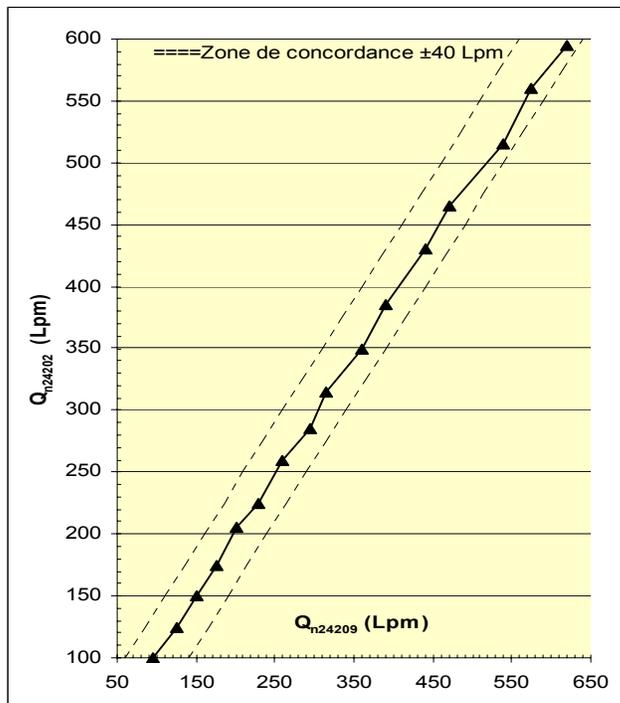
Figure 3 : Vérification de la réponse des rotamètres de marque Gilmont
