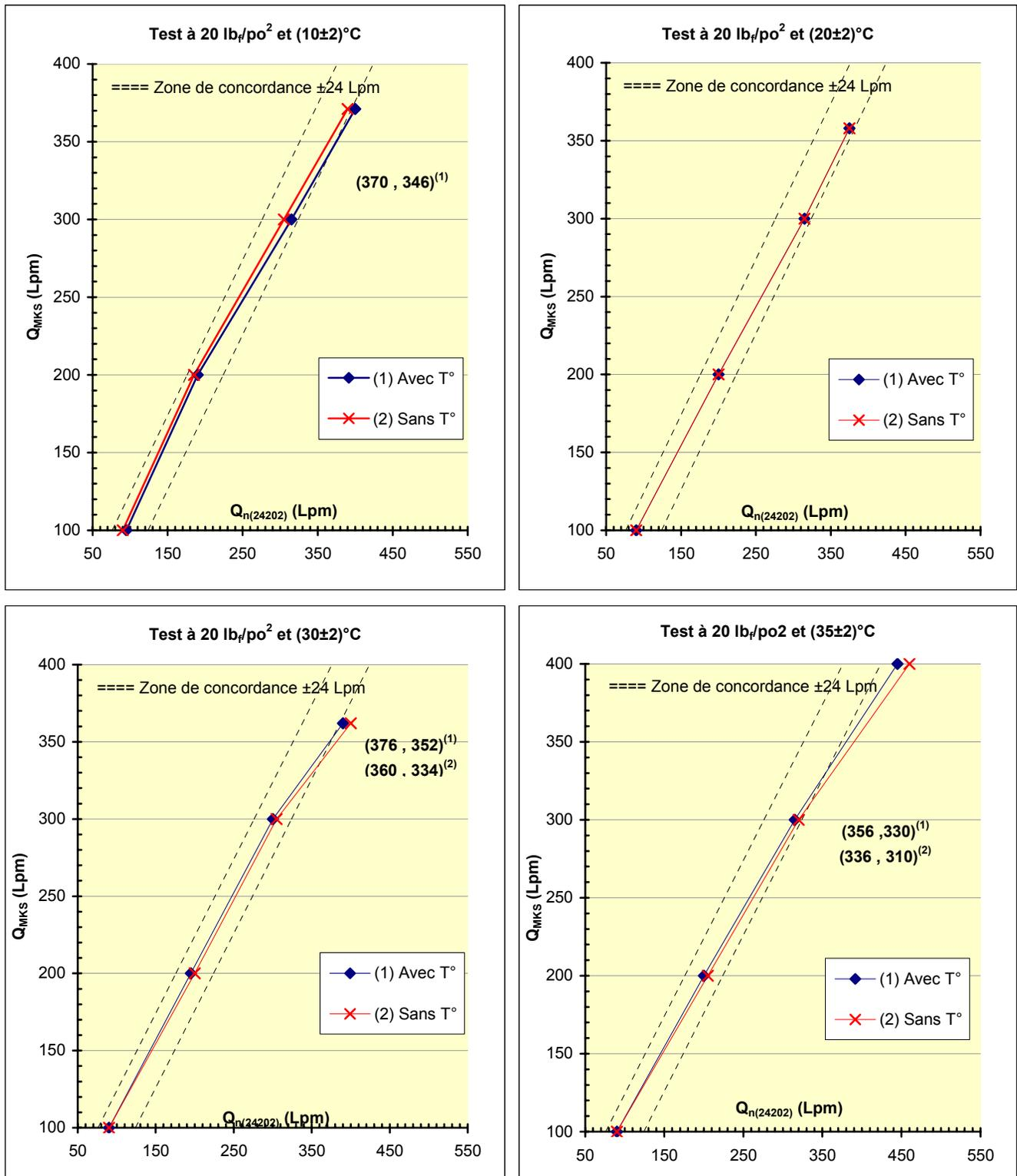
Figure 27 : Impact de la température sur le débit équivalent – Rotamètre Gilmont à 20 lb<sub>f</sub>/po<sup>2</sup>
