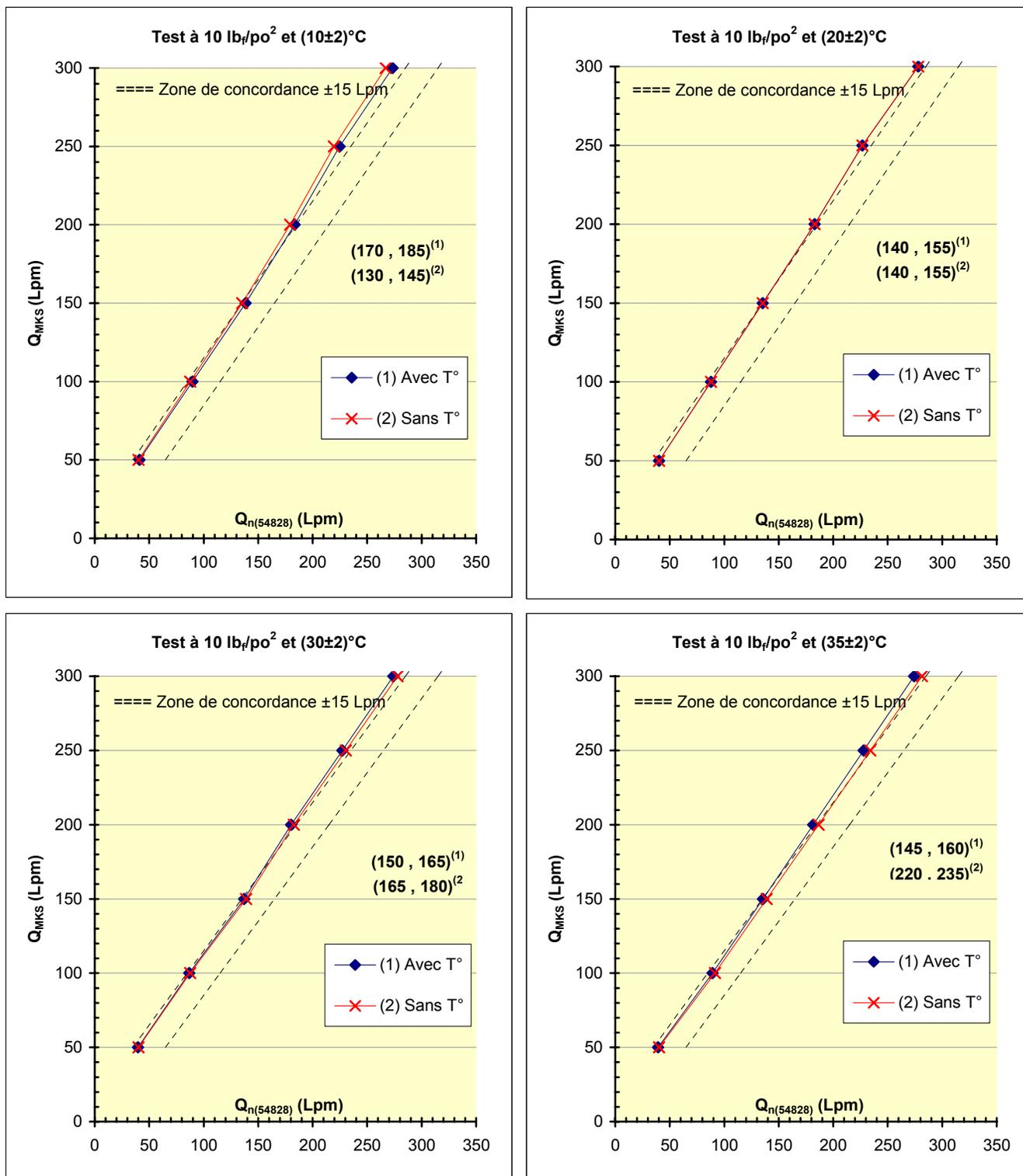
Figure 24 : Impact de la température sur le débit équivalent – Rotamètre Allegro à 10 lb<sub>f</sub>/po<sup>2</sup>
