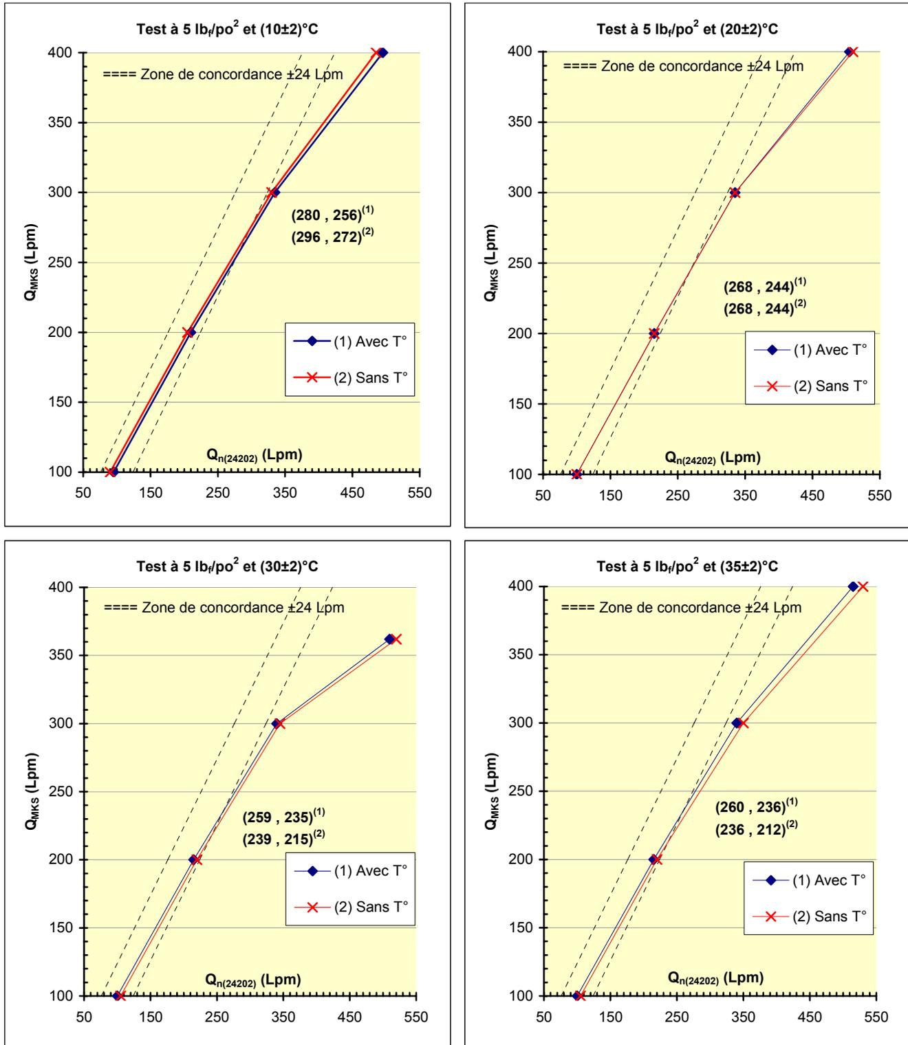
Figure 21 : Impact de la température sur le débit équivalent – Rotamètre Gilmont à  $5 \text{ lb}_f/\text{po}^2$
