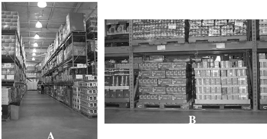
Figure 3.1 Allée avec aciers d'entreposage (A) et baie avec deux palettes et leurs produits (B)
