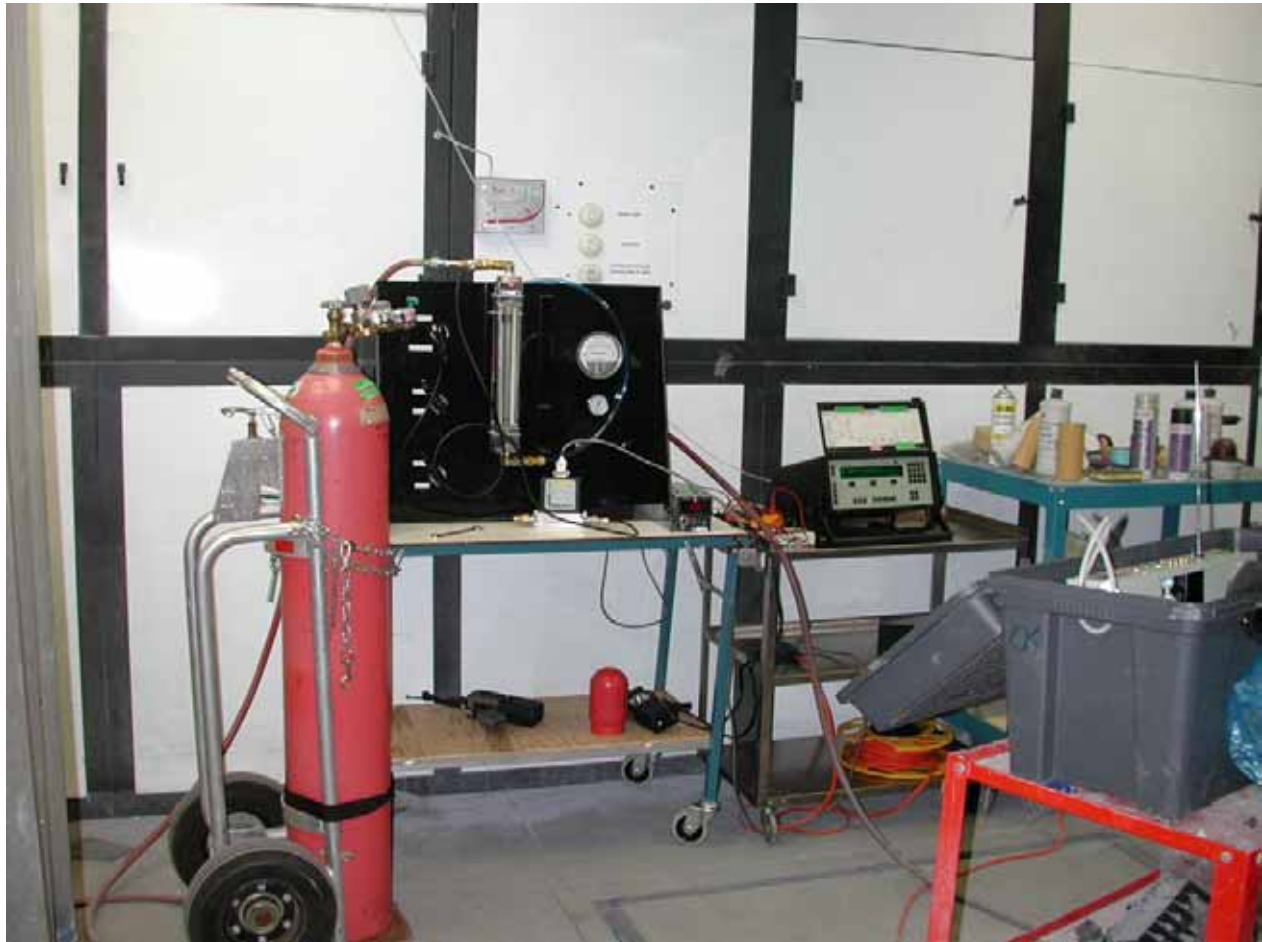
Photo 8 : Système d'injection du traceur
