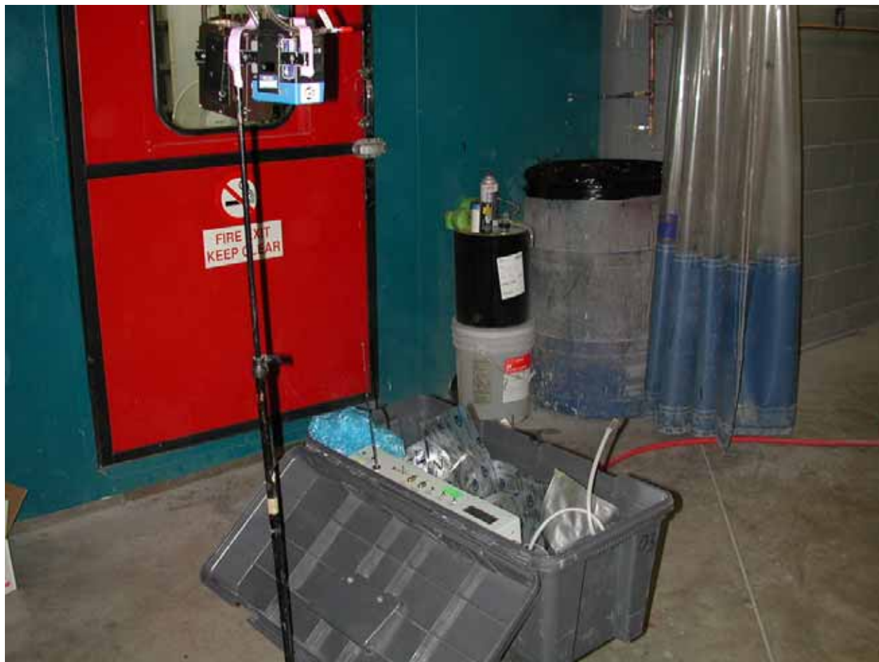
Photo 7 : Module de prélèvements automatisés et pompes d'échantillonnage
