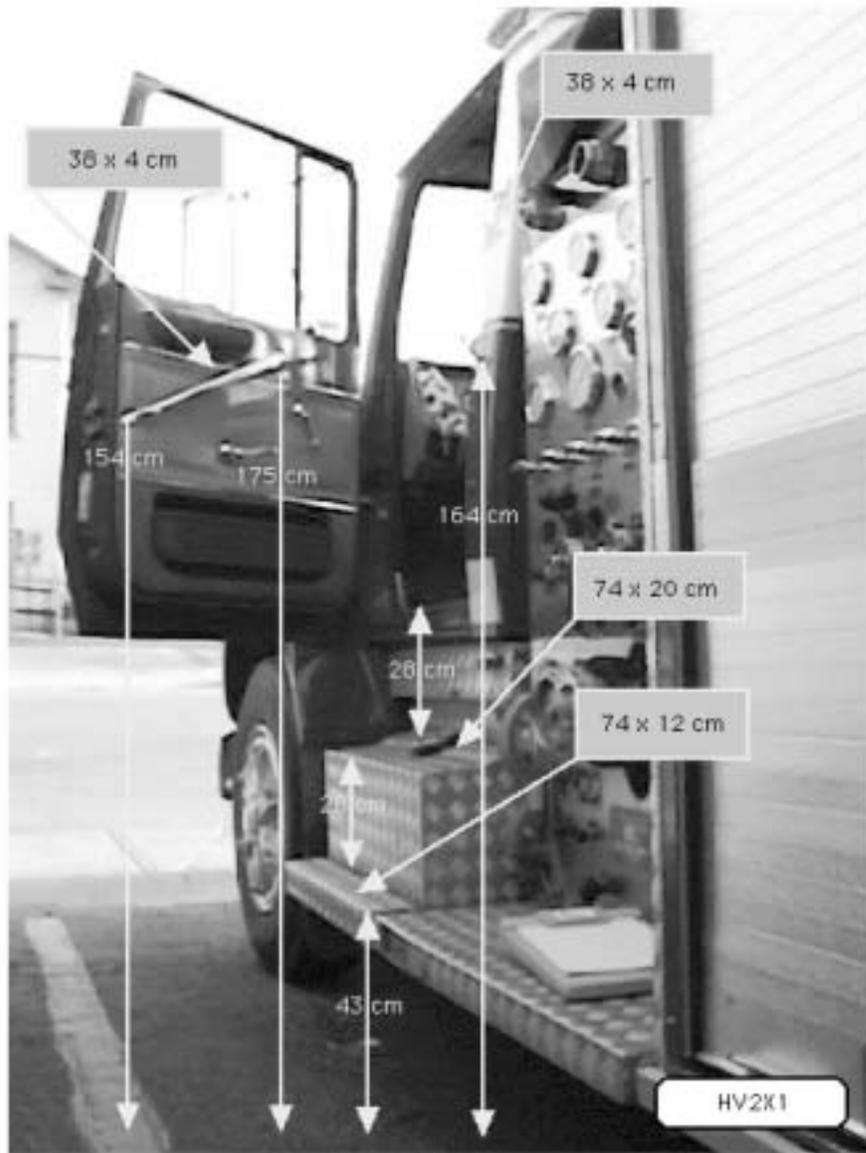
**Figure 4.11 - Dimensions des accès à la cabine de conduite du camion 90**
