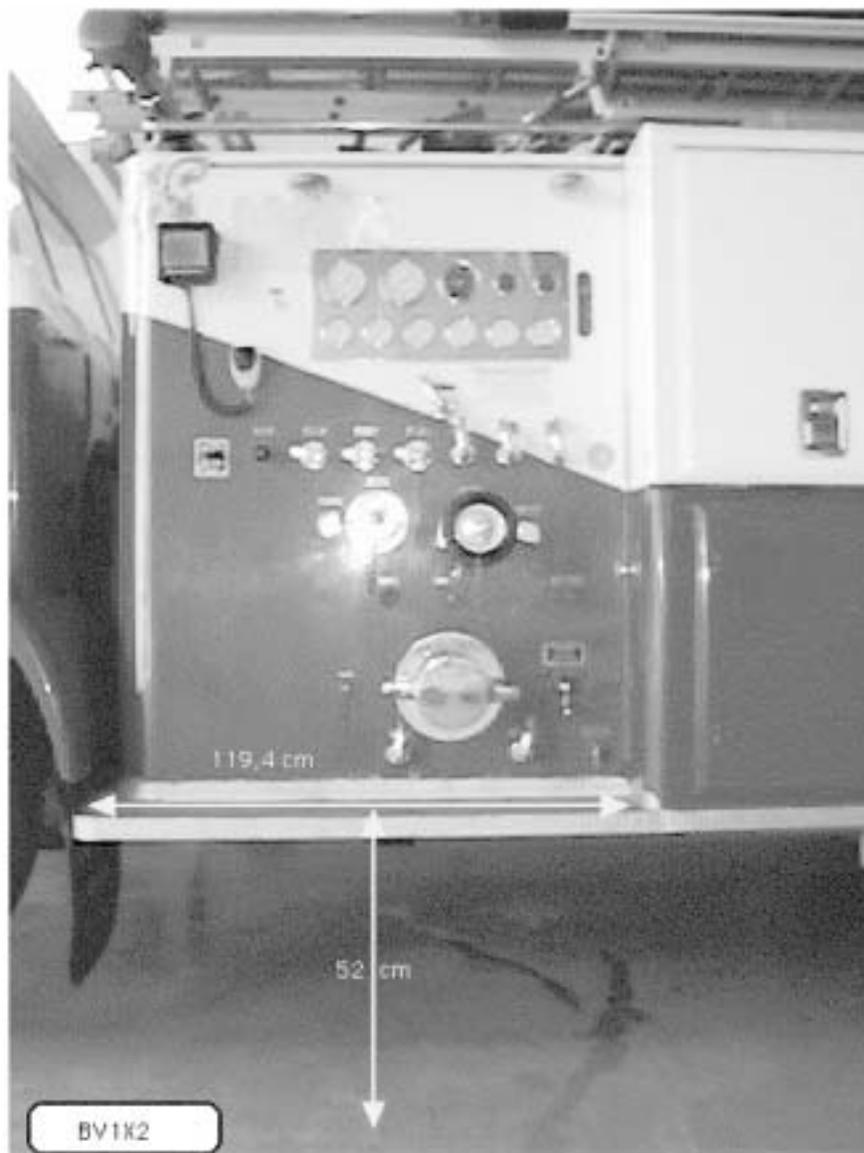
**Figure 4.35 - Exemple d'accès au dessus du véhicule par le côté**
