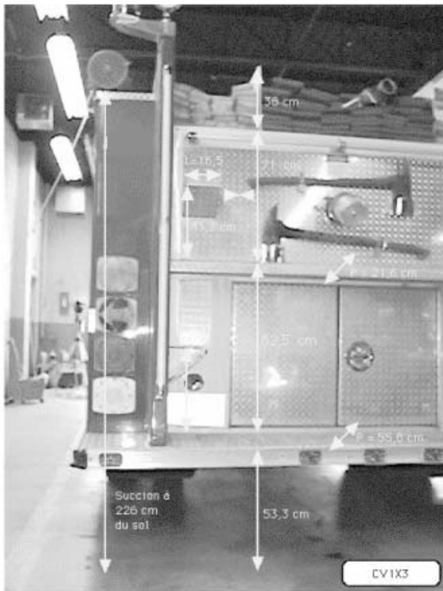
**Figure 4.26 - Dimensions de l'accès arrière au camion 50**
