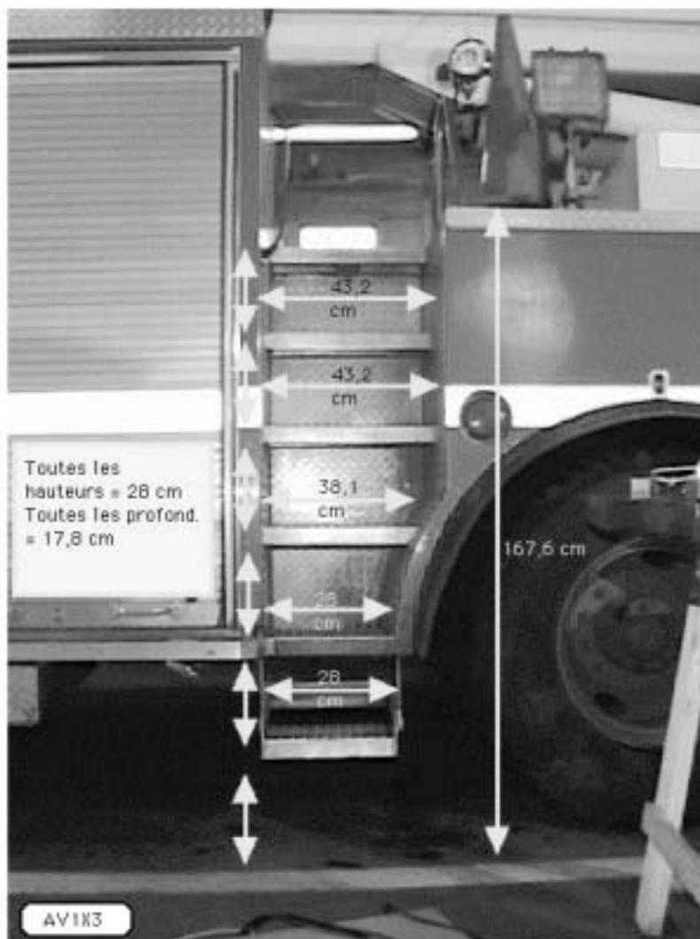
**Figure 4.20 - Dimensions des accès aux équipements mécaniques sur le véhicule 40**
