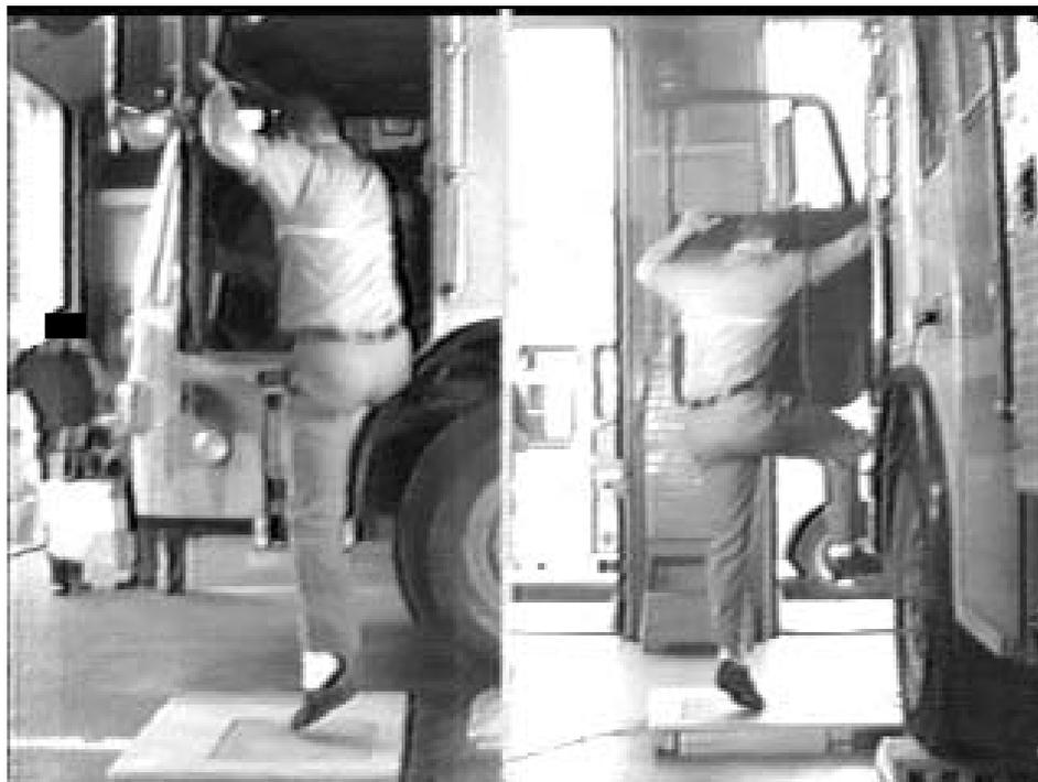
**Figure 3.7 - Installation de la plate-forme de force dans la caserne « B ». On remarque le véhicule d'urgence monté sur des blocs afin de l'exhausser à la hauteur de la plate-forme de force. Celle-ci est située au niveau de la portière de la cabine de conduite (Condition « CCP-face »)**
