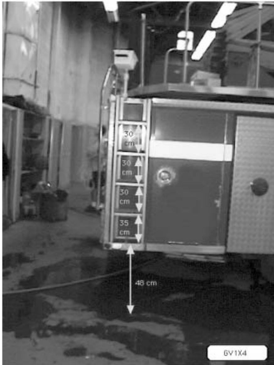
**Figure 4.23 - Dimensions de l'accès arrière au camion 20**
