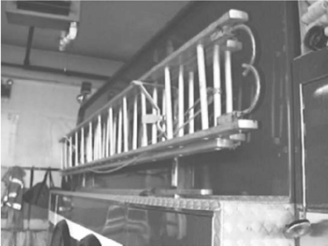
**Figure 4.76 - Échelles de longueurs différentes transportées sur un support latéral articulé**
