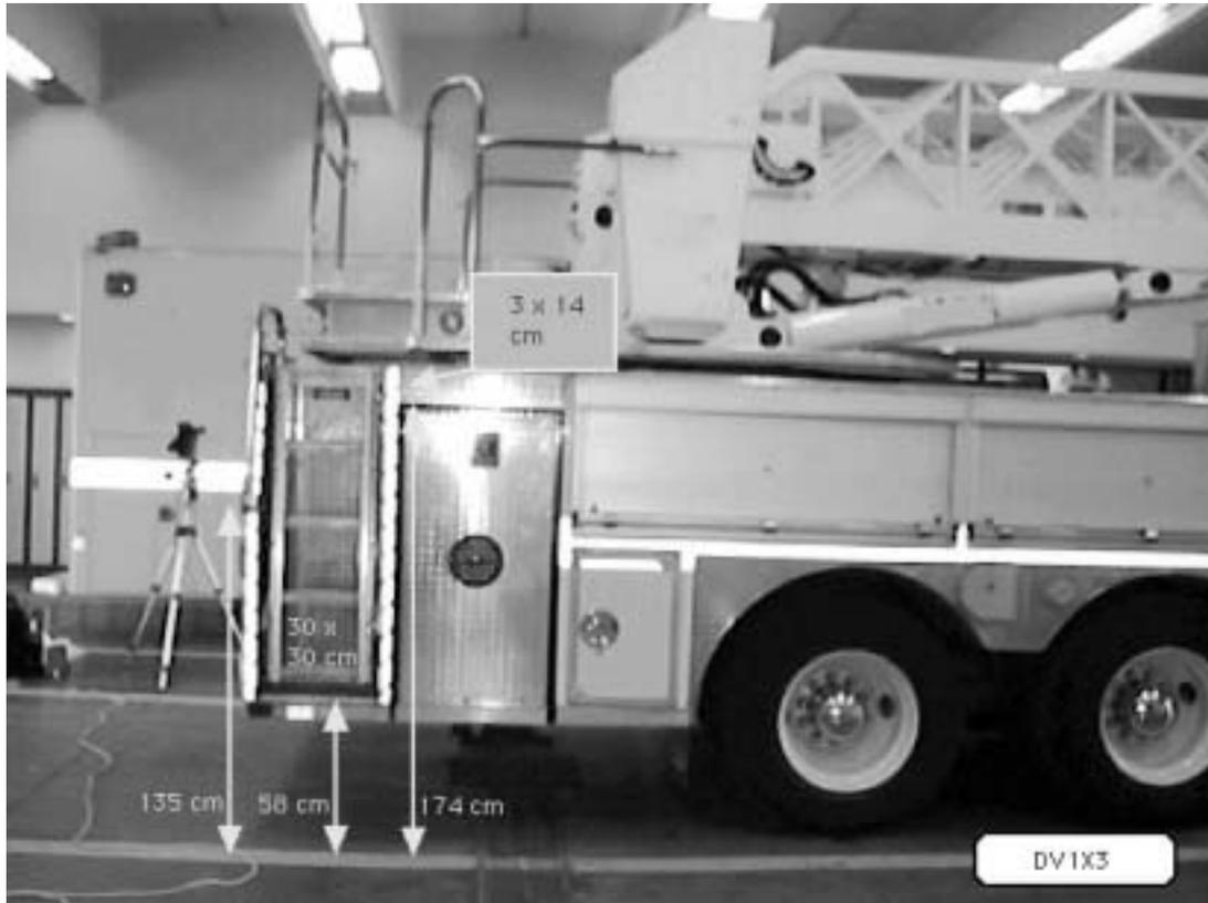
**Figure 4.21 - Même que 4.20, avec l'échelle d'accès abaissée**
