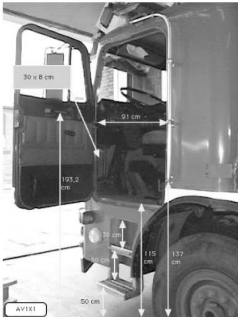
**Figure 4.2 - Dimensions des accès à la cabine de conduite du camion 20**
