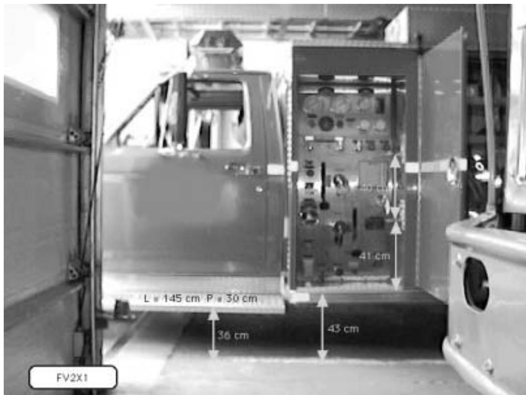
**Figure 4.33 - Dimensions des accès latéraux du camion 70**
