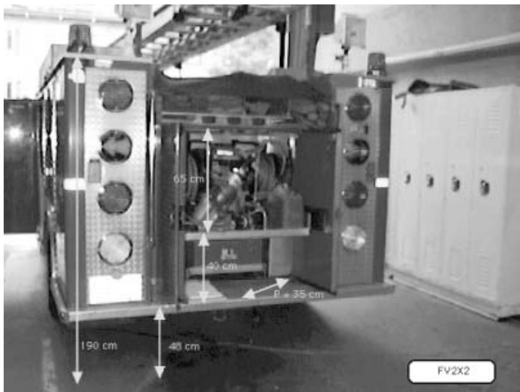
**Figure 4.29 - Dimensions de l'accès arrière au camion 70**
