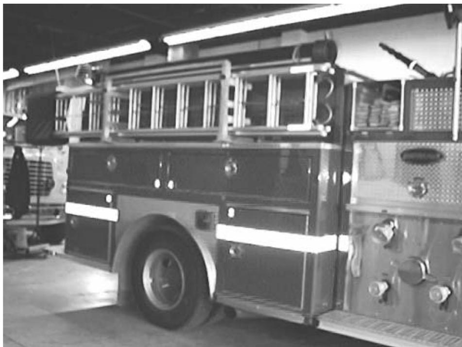
**Figure 4.77 - Échelles de longueurs différentes transportées à l'horizontal, dans un compartiment latéral**
