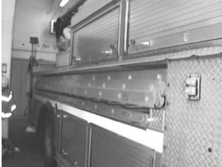
**Figure 4.78 - Échelles de longueurs différentes transportées à l'horizontale et à la verticale, dans un compartiment accessible par l'arrière**
