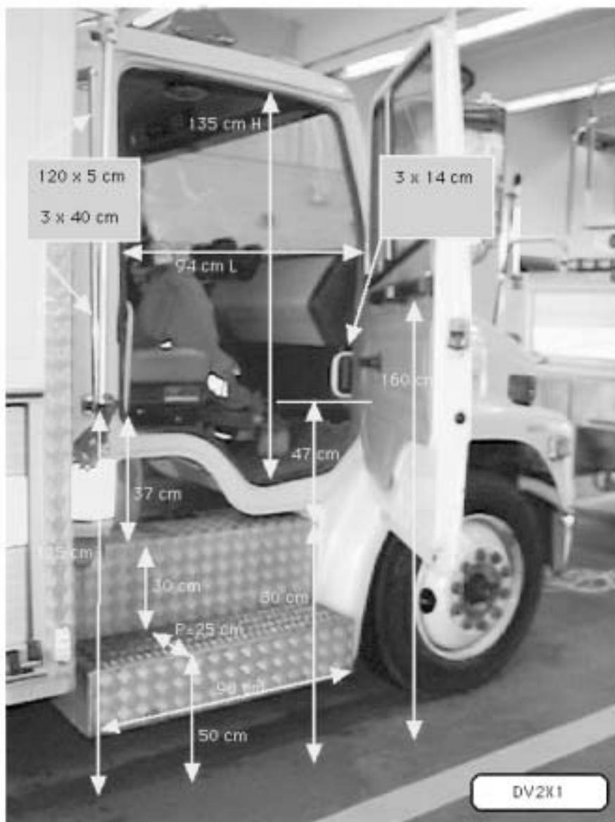
**Figure 4.6 - Dimensions des accès à la cabine de conduite du camion 50**
