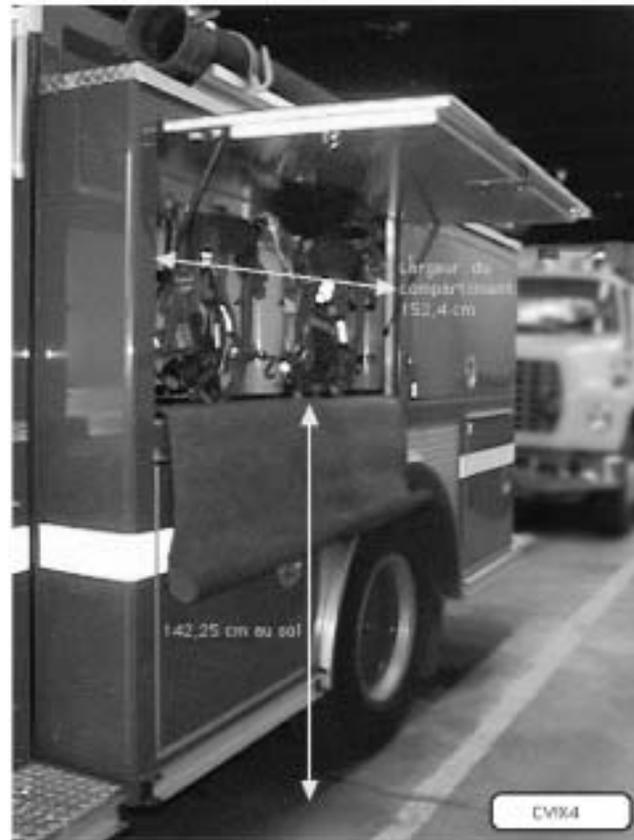
**Figure 4.92 - Autre exemple de transport d'ARA dans des compartiments latéraux à charnières horizontales**
