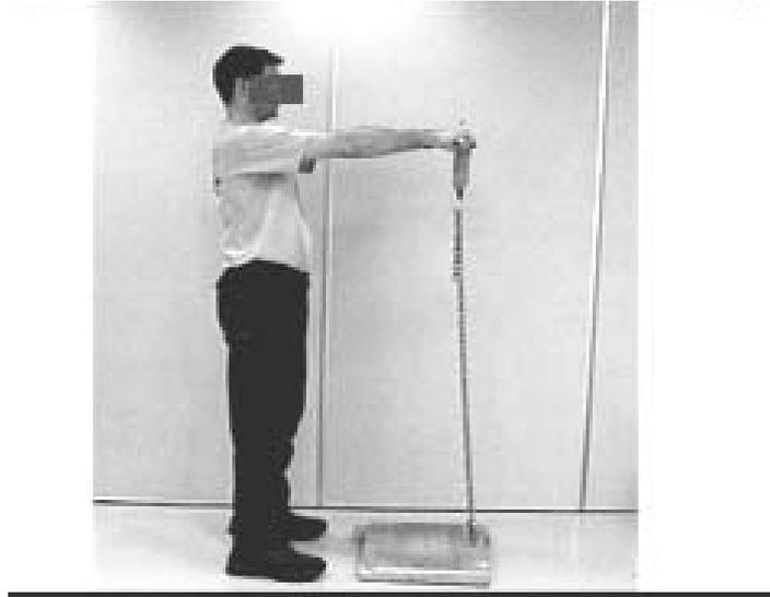
**Figure 3.13 - Test d'effort musculaire maximum pour le dos. La longueur de la chaîne qui relie le dynamomètre au socle est ajustée selon la taille du sujet**
