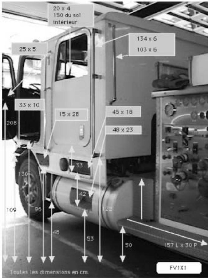
**Figure 4.8 - Dimensions des accès à la cabine de conduite du camion 70**
