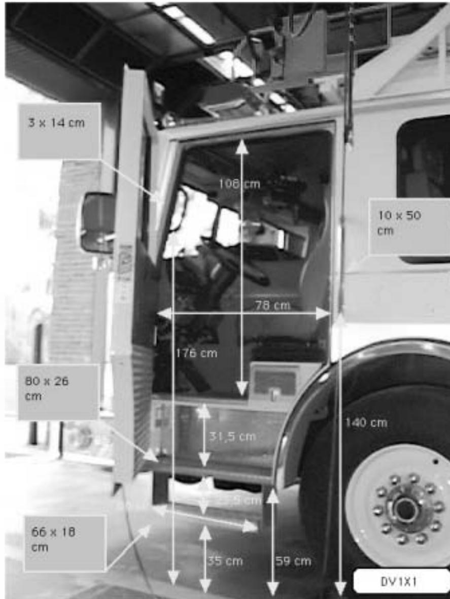
**Figure 4.5 - Dimensions des accès à la cabine de conduite du camion 41**
