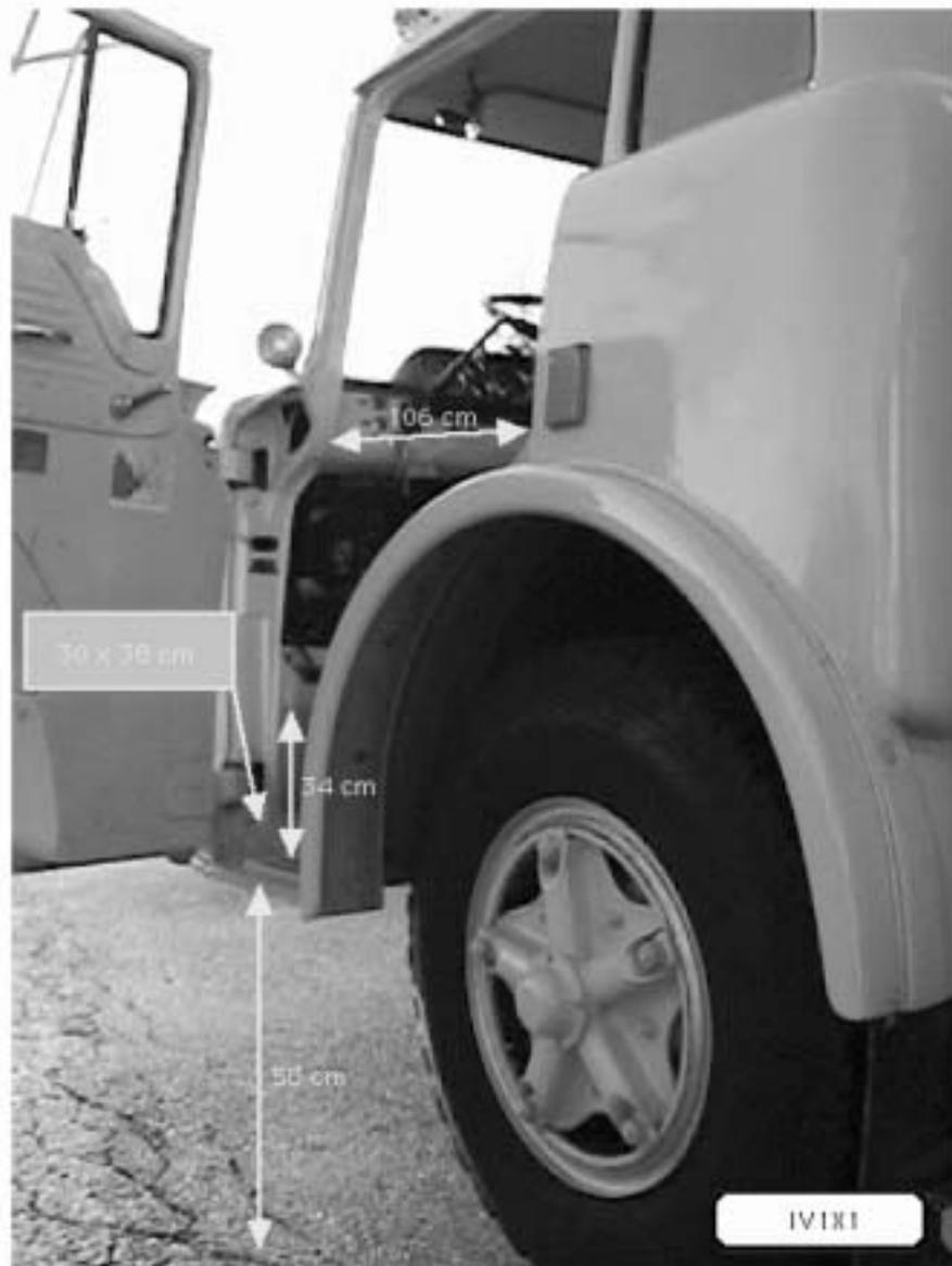
**Figure 4.12 - Dimensions des accès à la cabine de conduite du camion 91**
