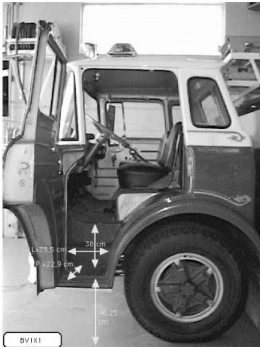
**Figure 4.3 - Dimensions des accès à la cabine de conduite du camion 21**
