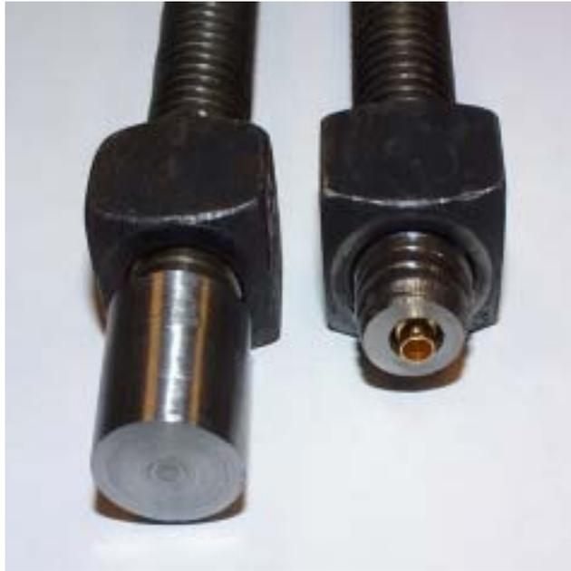
Figure 32 : Capuchon de protection métallique vissable
