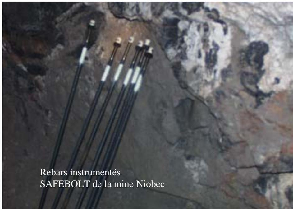
Figure 19 : « Rebars » instrumentés SAFEBOLT avant leur installation
