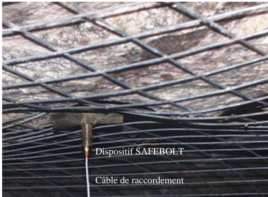
Figure 20 : Mesure des charges axiales dans la mine de Niobec à l'aide du système SAFEBOLT
