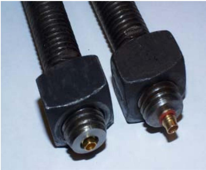
Figure 33 : Position initiale (à droite) et modifiée (à gauche) du raccord
