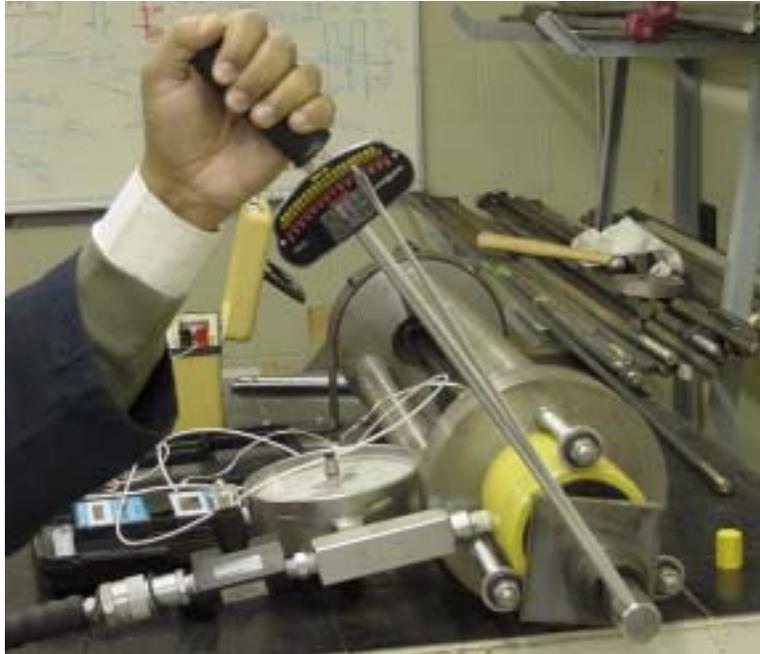
Figure 14 : Application d'une charge axiale au boulon à l'aide d'une clé dynamométrique
