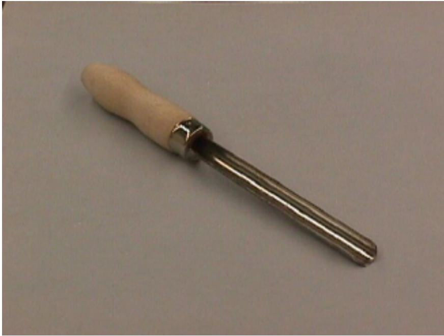
Figure 11 Outil utilisé pour percer les trous dans les dessus des cuvettes
