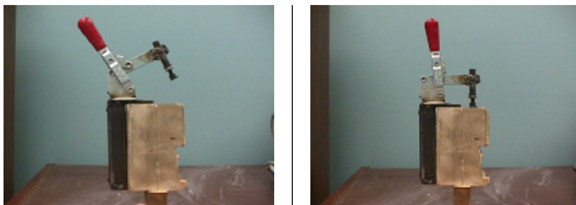
Figure 21. Vue d'ensemble du nouveau serre-pièce
