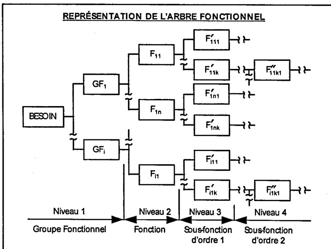
Figure 3 L'arbre fonctionnel<sup>3</sup>
