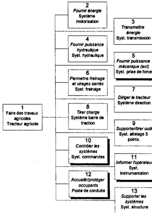
Figure 5.1 Décomposition fonctionnelle du tracteur agricole<sup>5</sup>
