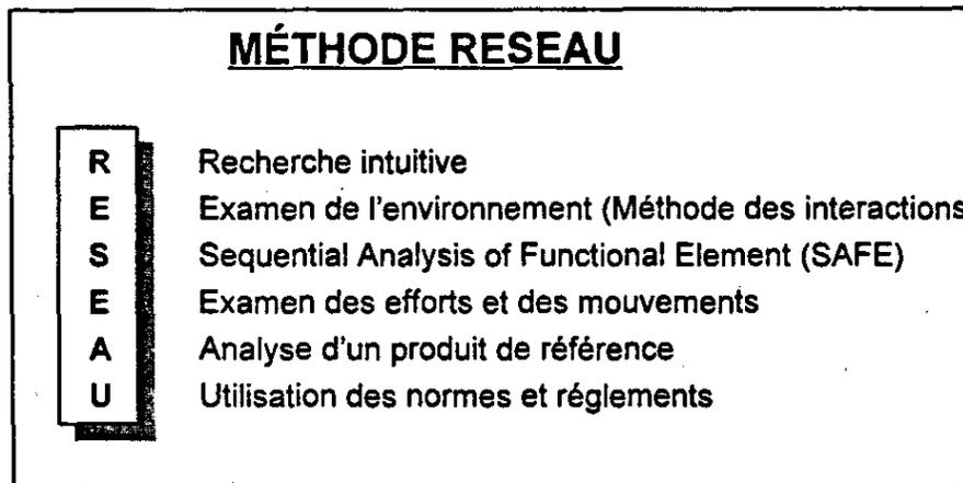
Figure 2 Les méthodes de recherche des fonctions <sup>2</sup>.
