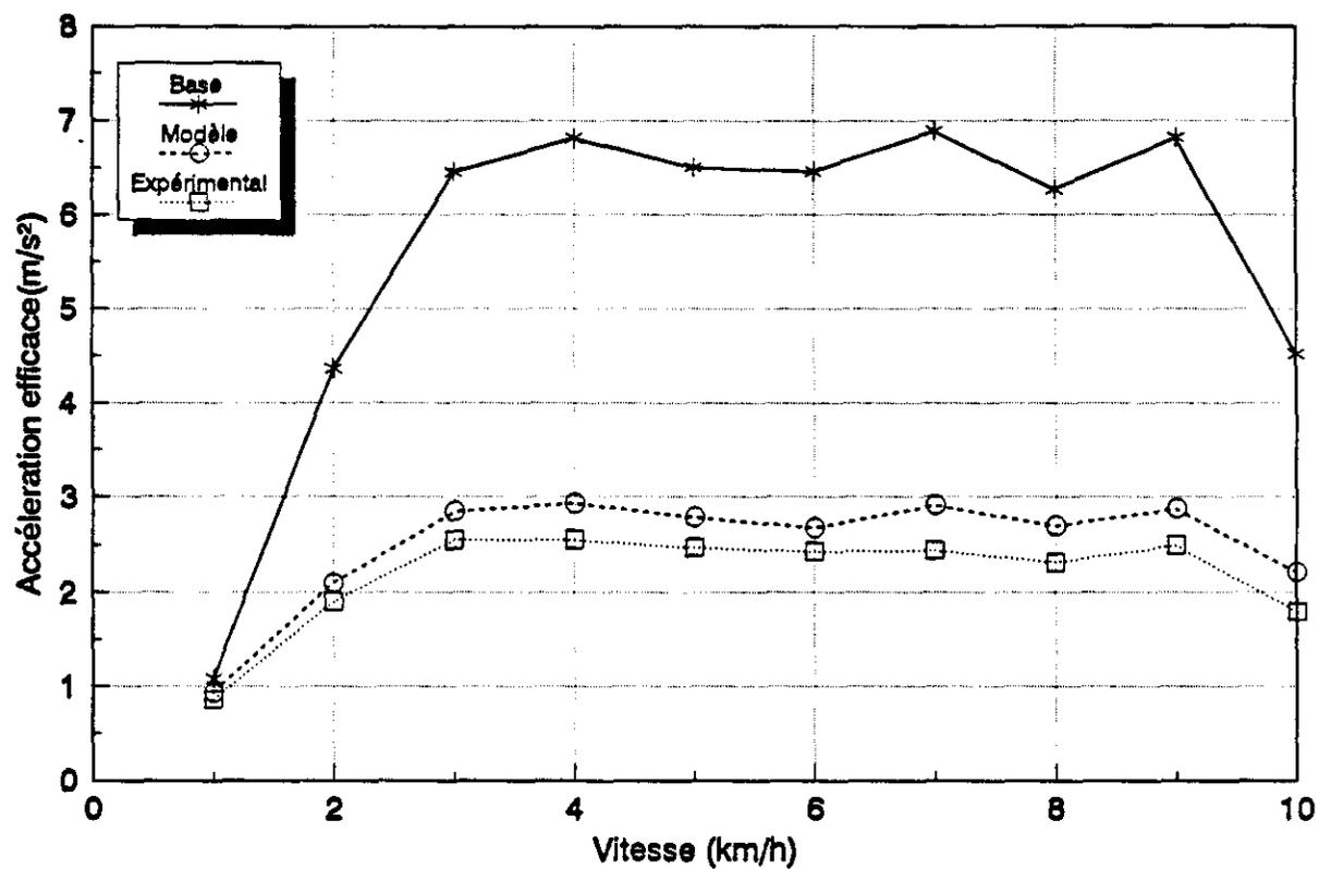
Figure 17. Validation du modèle analytique sous l'influence de chocs ou transitoires (basée sur les mesures effectuées avec le siège SIFRA)
