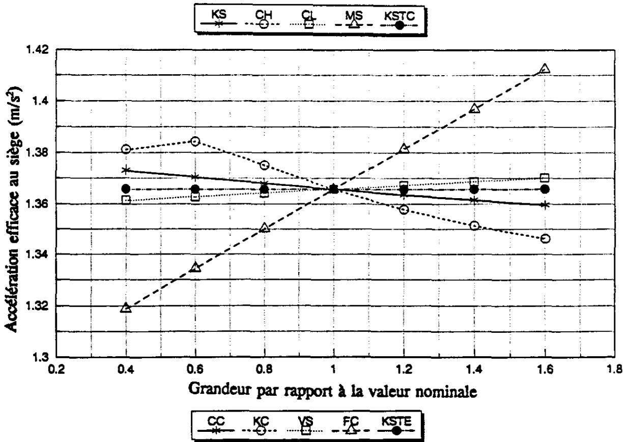
Figure 21. Influence des paramètres caractérisant le siège SIFRA
