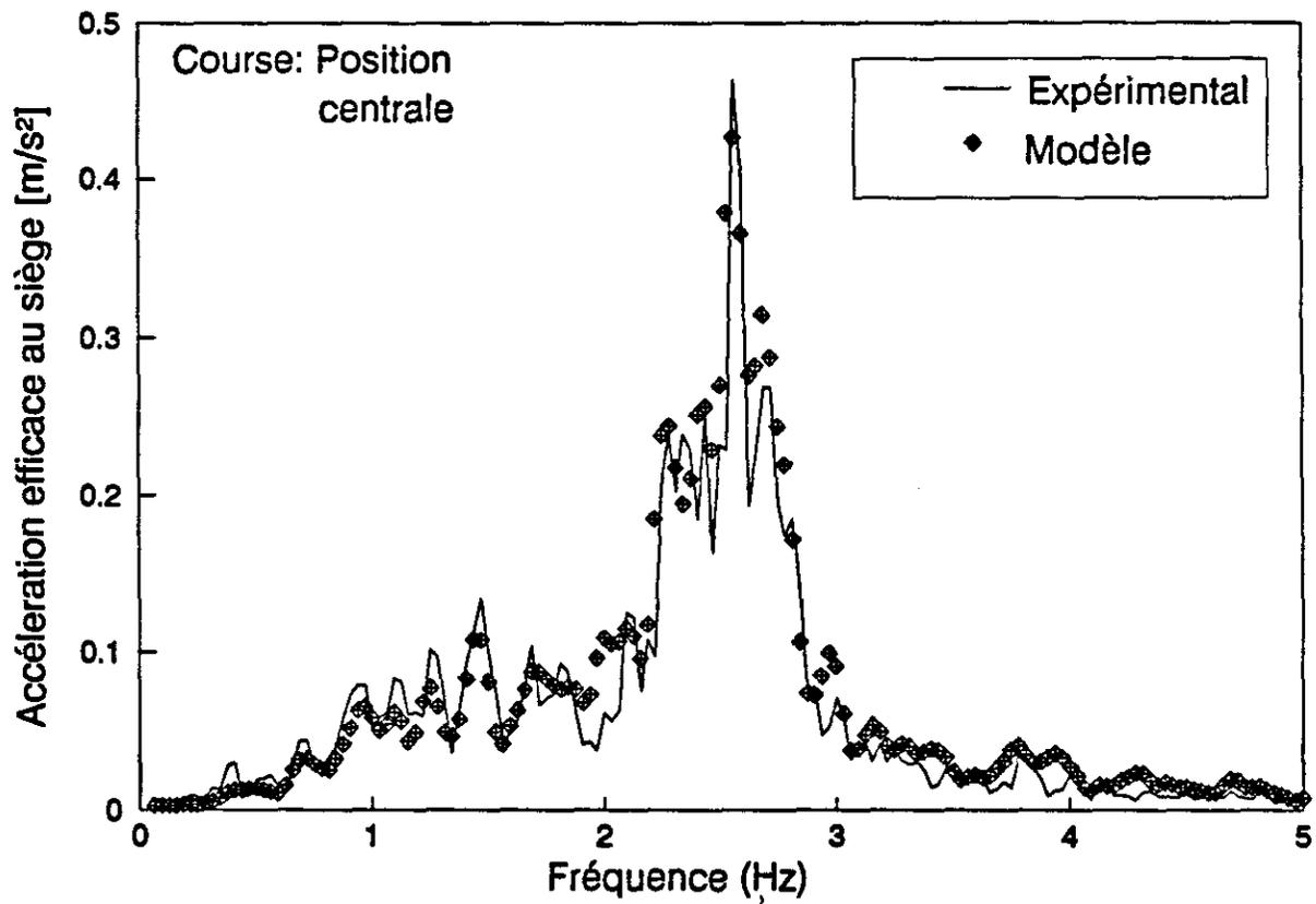
Figure 18. Validation du modèle analytique sous l'influence de vibrations aléatoires de classe ISO 2 (basée sur les mesures effectuées avec le siège SIFRA)
