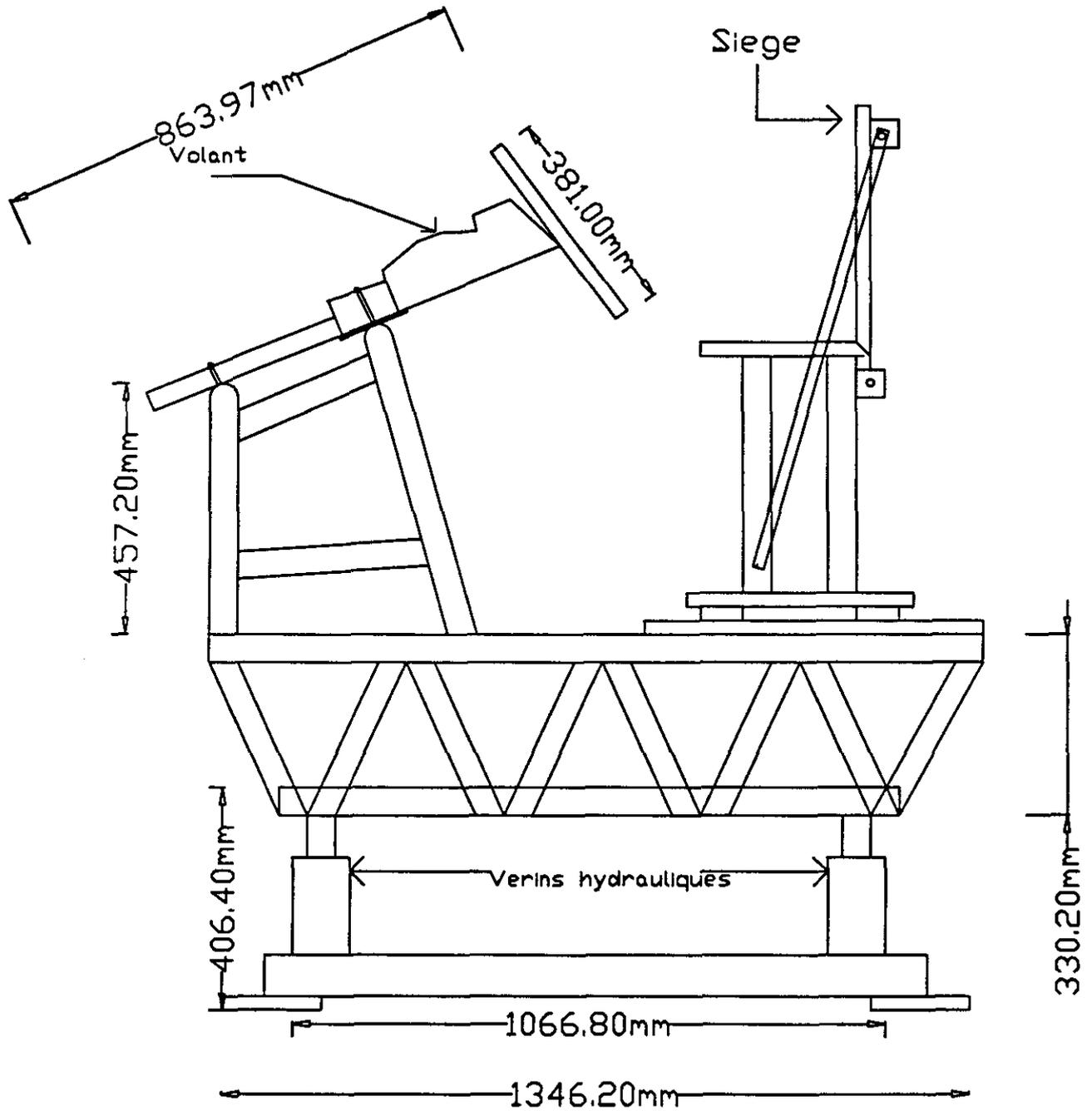
Figure 3. Représentation schématique du simulateur de vibrations
