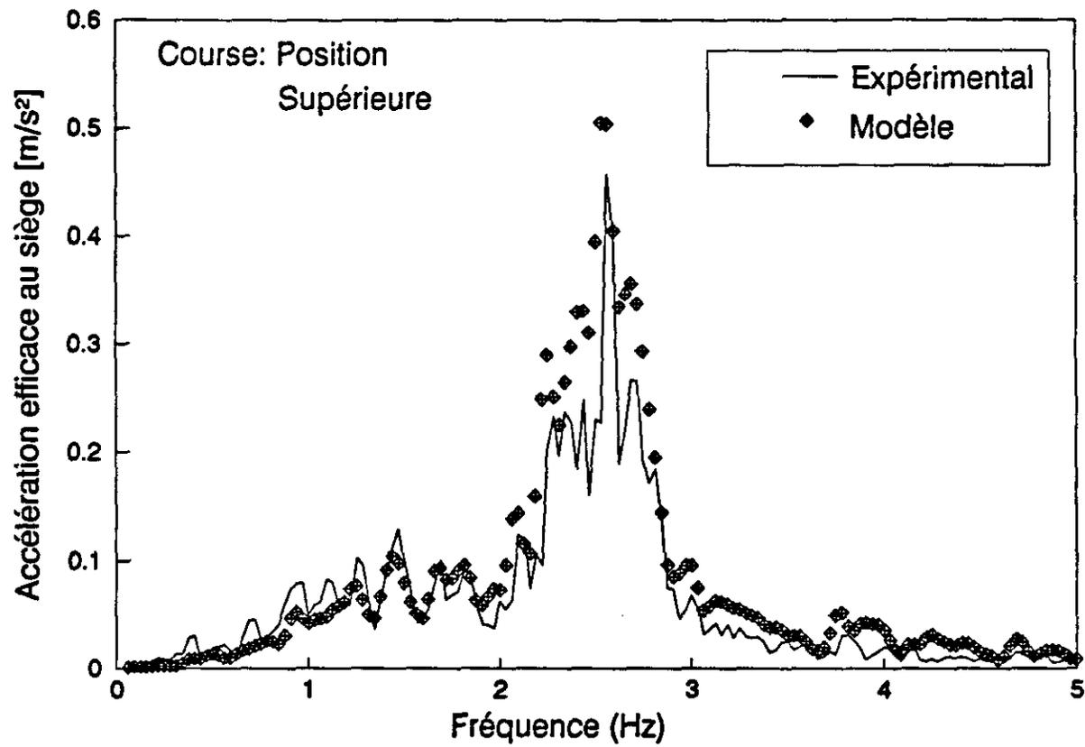
Figure 20. Modèle prévisionnel du siège SIFRA lorsque la course est en position supérieure (excitation ISO 2)
