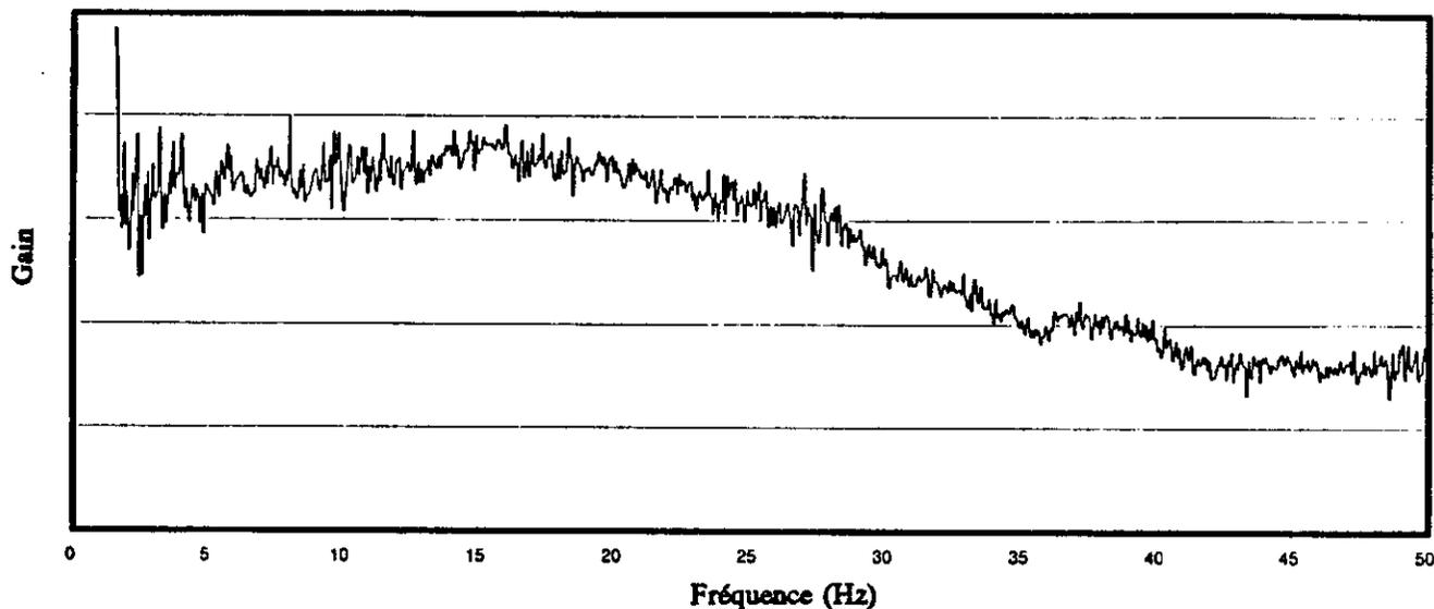
Figure 5. Réponse en fréquences du simulateur de vibrations
