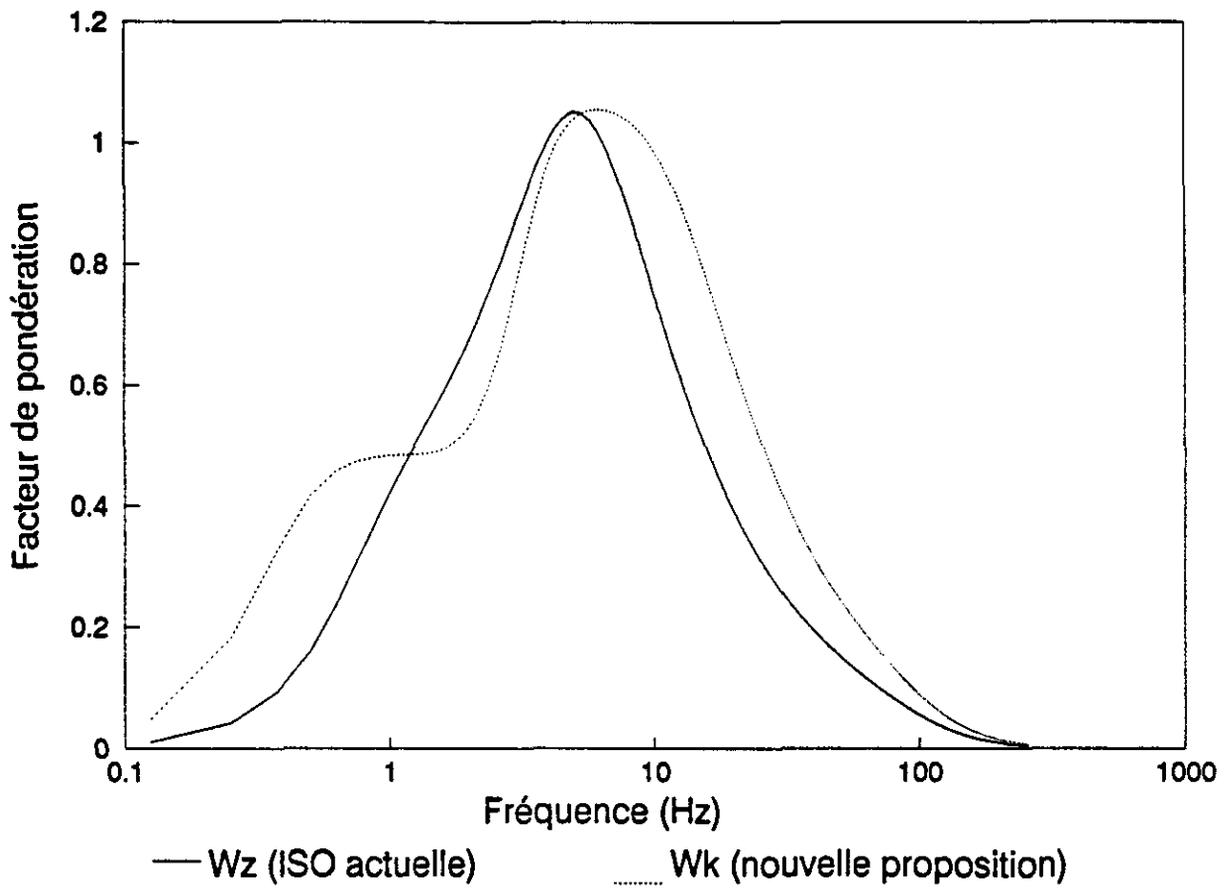
Figure 7. Courbes de pondération en fréquences définies dans les normes pour les vibrations verticales
