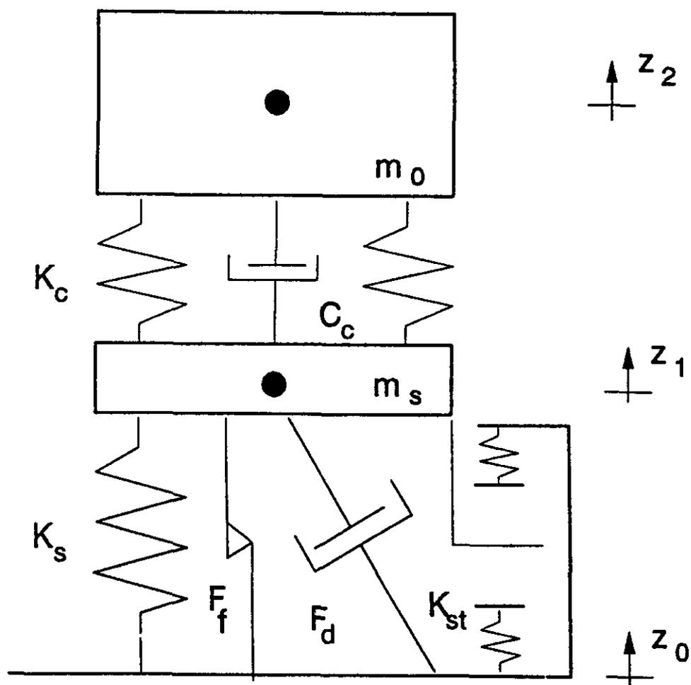
Figure 16. Modèle analytique des sièges à suspension
